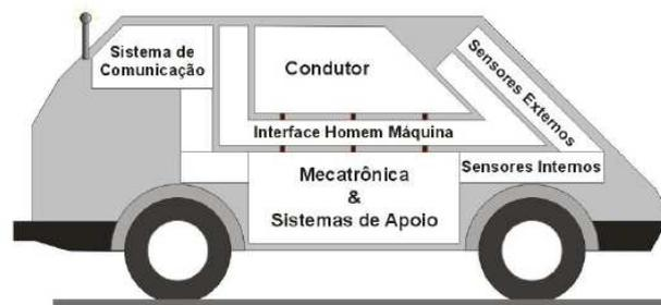
Figura 2.1 – Esquemático de um veículo inteligente. (Osório F. S., 2004)
