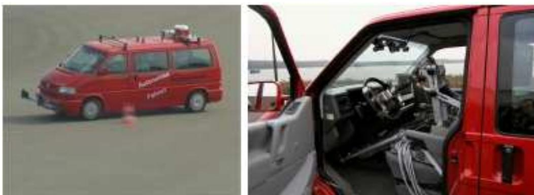
Figura 2.7– Projeto *Autonomes Fahren* (Volkswagen) – Robô motorista (Osório F. S., 2004)
