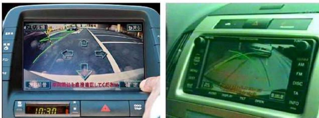
Figura 2.3 – Sistema de auxílio para estacionamento. (Osório F. S. e Heinen, F.; Fortes, L., 2000)
