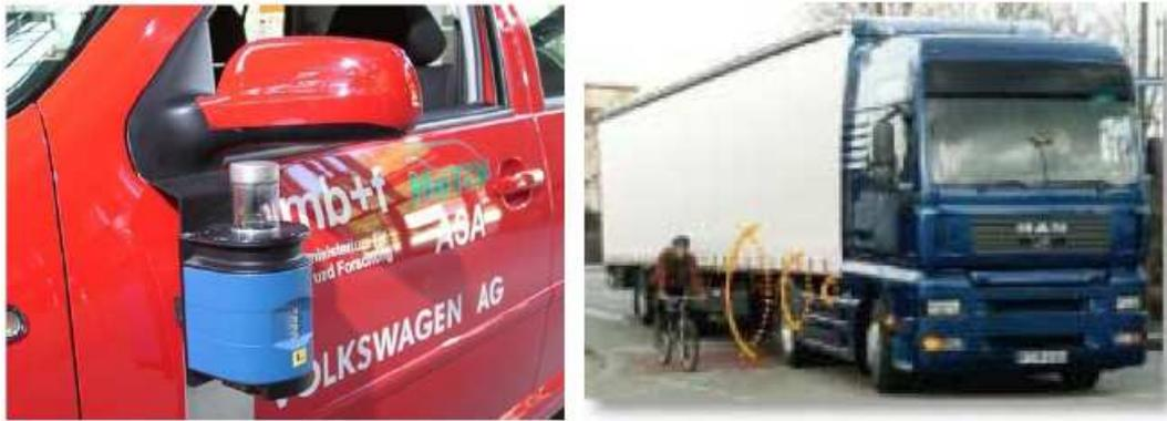
Figura 2.4– Sistema de identificação dos pontos cegos do veículo. (Osório F. S. e Heinen, F.; Fortes, L., 2000)
