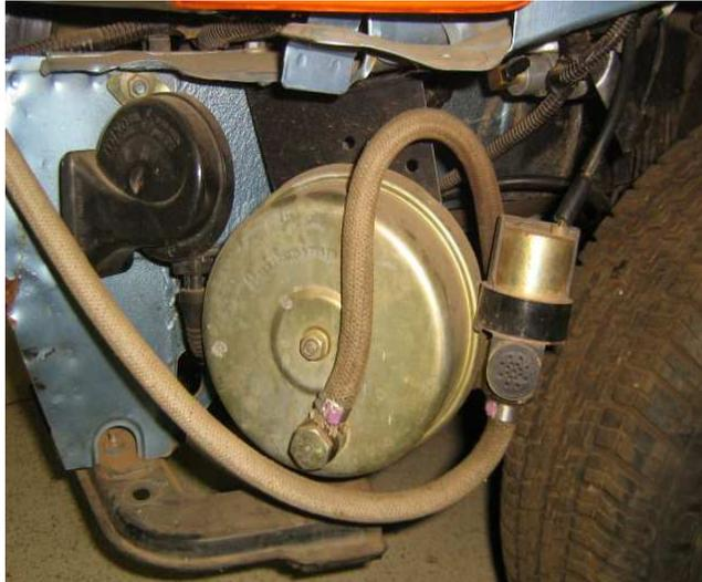
Figura 1.6 – Foto do sistema de acionamento da embreagem (Bellardi, T., 2005).
