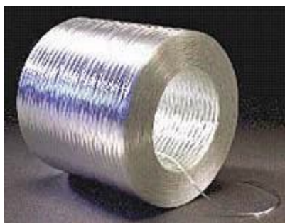
Figura 1.12 – Roving Contínuo para Filament Winding [20].
