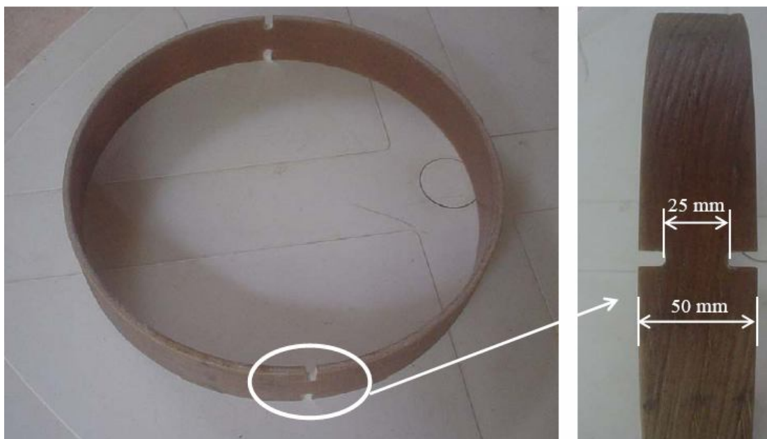
Figura 1.6 –. Corpo-de-prova para ensaios de tração circunferencial [13].
