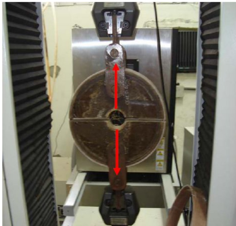
Figura 1.5 – Dispositivo de ensaio split disc [13].
