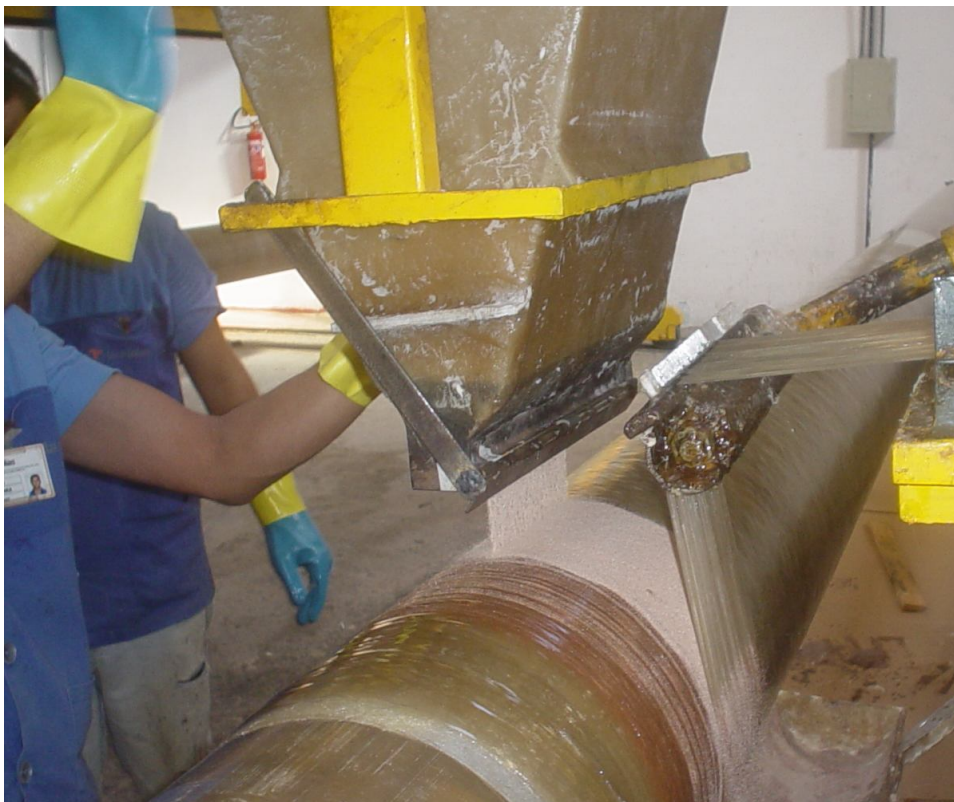
Figura 1.10 – Utilização de areia na fabricação de tubos em PRFV [13].
