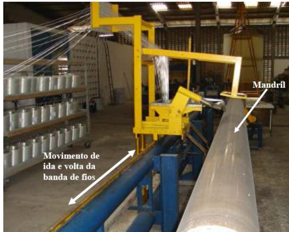
Figura 1.13 – Processo de bobinagem contínua [13].
