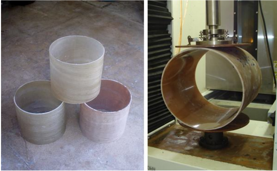
Figura 1.4 – Corpos-de-prova e ensaio de rigidez [13].
