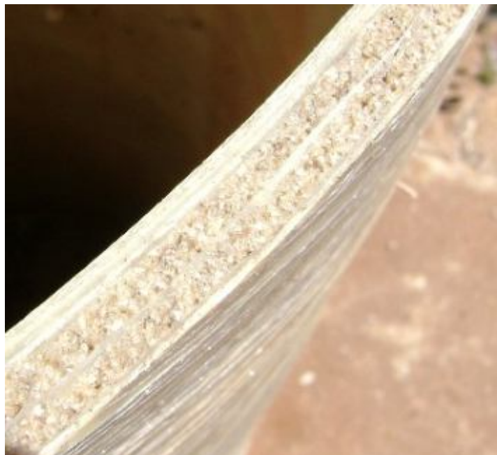
Figura 1.9. Detalhe da seção de um tubo PRFV.
