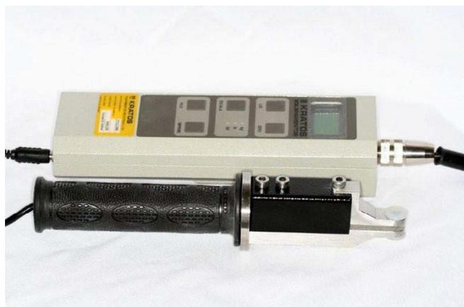
Figura 1. Dinamômetro digital com capacidade até 100 quilogramas-força (Kgf)
