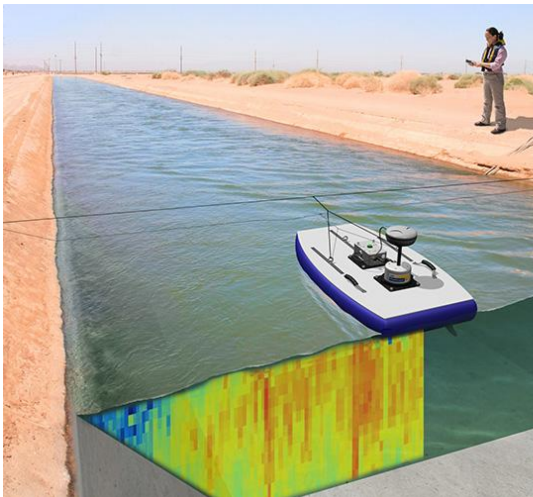
Figura 9: Representação de um medidor de vazão acústico sendo utilizado ao longo de uma travessia. Na imagem é possível ter uma idéia de variação de vazão ao longo da seção transversal, em que cores quentes representam maiores vazões, em contraste com vazões mais baixas em cores mais frias. Imagem retirada de: http://www.huntercaprez.ch/images/produkte/RiverSurveyor_Messung.jpg .
