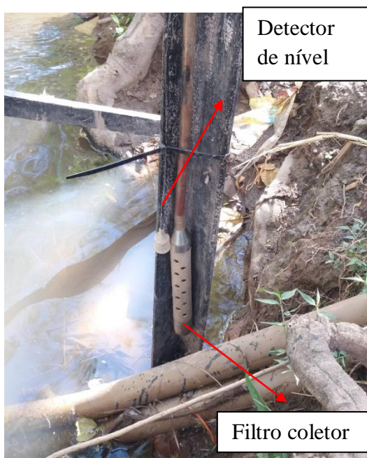
Figura 14: Amostragem fixa de água e sedimentos. O filtro coletor permanecia fixo durante as cheias no Córrego Riacho Fundo. Foto: próprio autor (2016)
