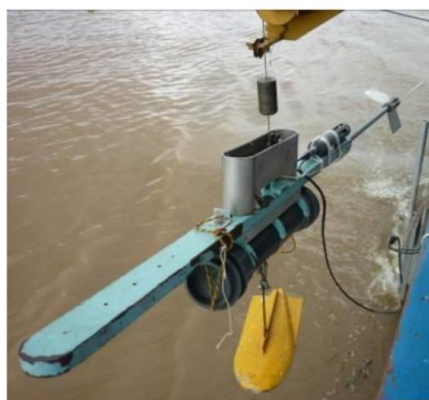
Figura 11: Processo de amostragem pontual instantânea. (A) Amostrador pontual instantâneo do tipo Calléde com lastro de 50kg utilizado em rios da Amazônia; (B) Parte da seção do Rio Purus com a localização da amostragem nas verticais 1 e 2. Fonte: Adaptado de Santos (2013)
