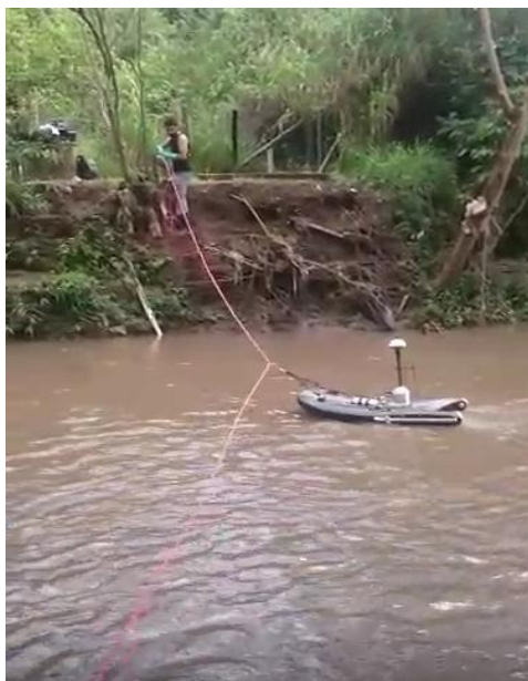
Figura 18: Medição de descarga líquida com uso do M9 River Surveyor®, da Sontek, no Córrego Riacho Fundo, Estação fluviométrica 60478200 (Código ANA) Montante Zoológico. Foto: Elton Souza (2017c)
