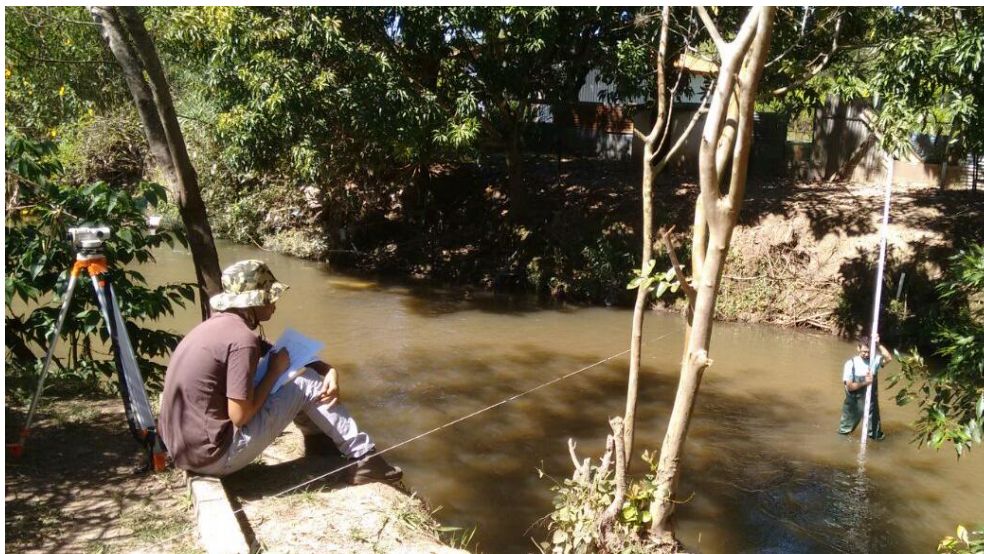
Figura 17: Levantamento do perfil topográfico na estação 60478200 Montante Zoo, com nível óptico, pelo método de Nivelamento Geométrico por Visadas Extremas em junho de 2017. Foto: Farias (2017)
