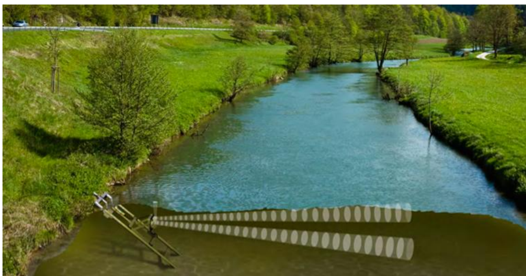
Figura 8: Medidor de vazão acústico fixado na margem de um canal. Retirado de: http://www.clean.com.br/Servico/Index/medicao-de-vazao
