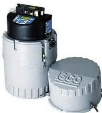
Figura 12: Amostrador automático ISCO 6712. Este equipamento bombeia água com sedimentos a partir da programação realizada. Assim, o amostrador pode ser acionado para coletar em diversas situações, sem depender de um técnico estar presente no momento da amostragem. Pode ser programado para coletar em função do tempo, acionado baseado no nível da cota, chuva ou fluxo da água no rio. Imagem retirada de: http://img.directindustry.com/pt/images_di/photo-g/22360-2881231.jpg .
