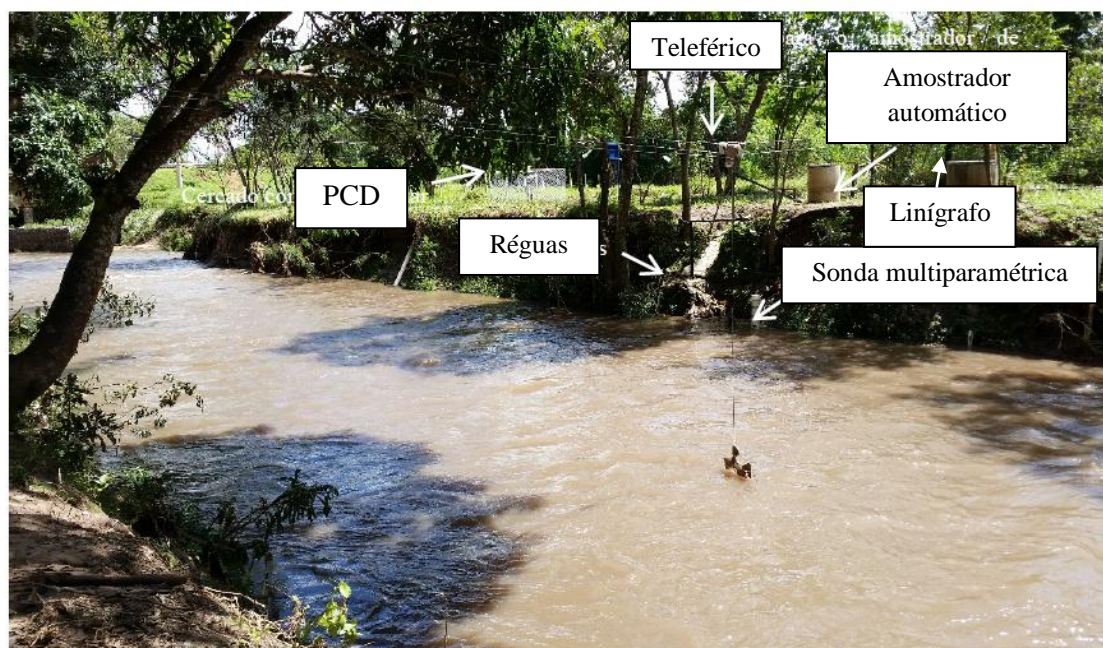
Figura 13: Visão de toda estação fluviossedimentométrica, onde ocorreu o presente estudo. Na data em que a foto foi tirada, o teleférico ainda não havia sido destruído por enchente e a infraestrutura de fluviabilidade da sonda e amostrador automático ainda não haviam sido feitas. Fonte: Aguiar (2015).
