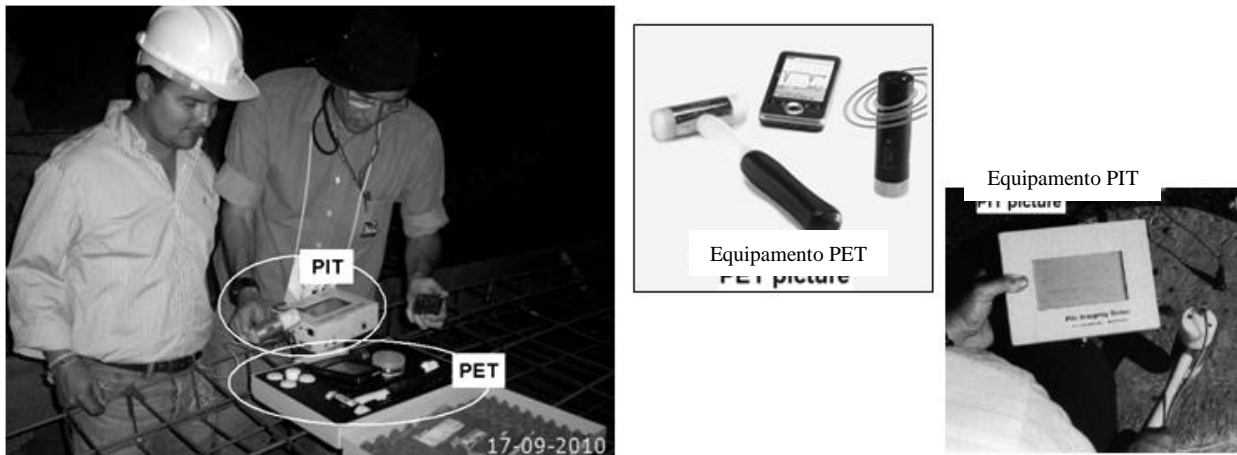
Figura 2.18 – Montagem e detalhes dos sistemas PIT e PET no campo experimental Cunha et al. , (2012).
