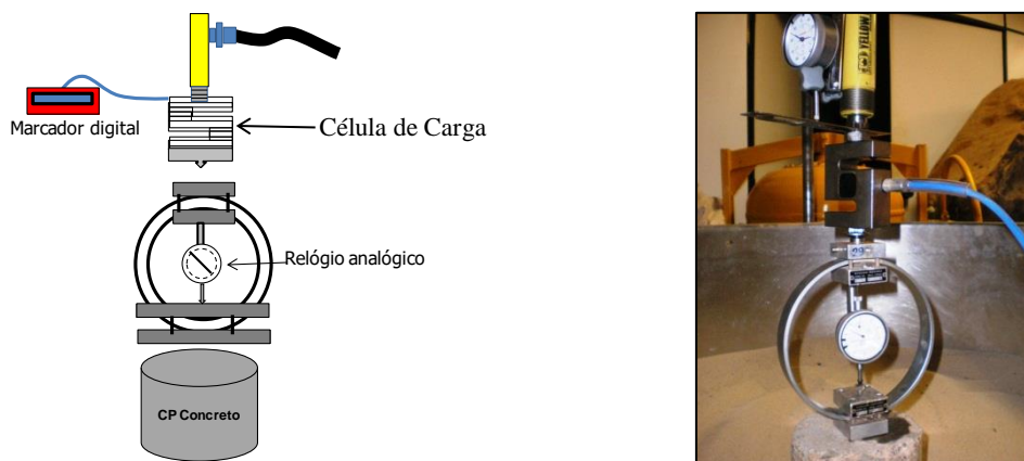
Figura 3.17 – Ensaio de Calibração do sistema de leitura de carga.
