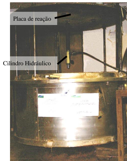
Figura 3.2 – Sistema de prova de carga em modelo reduzido, 1g.
