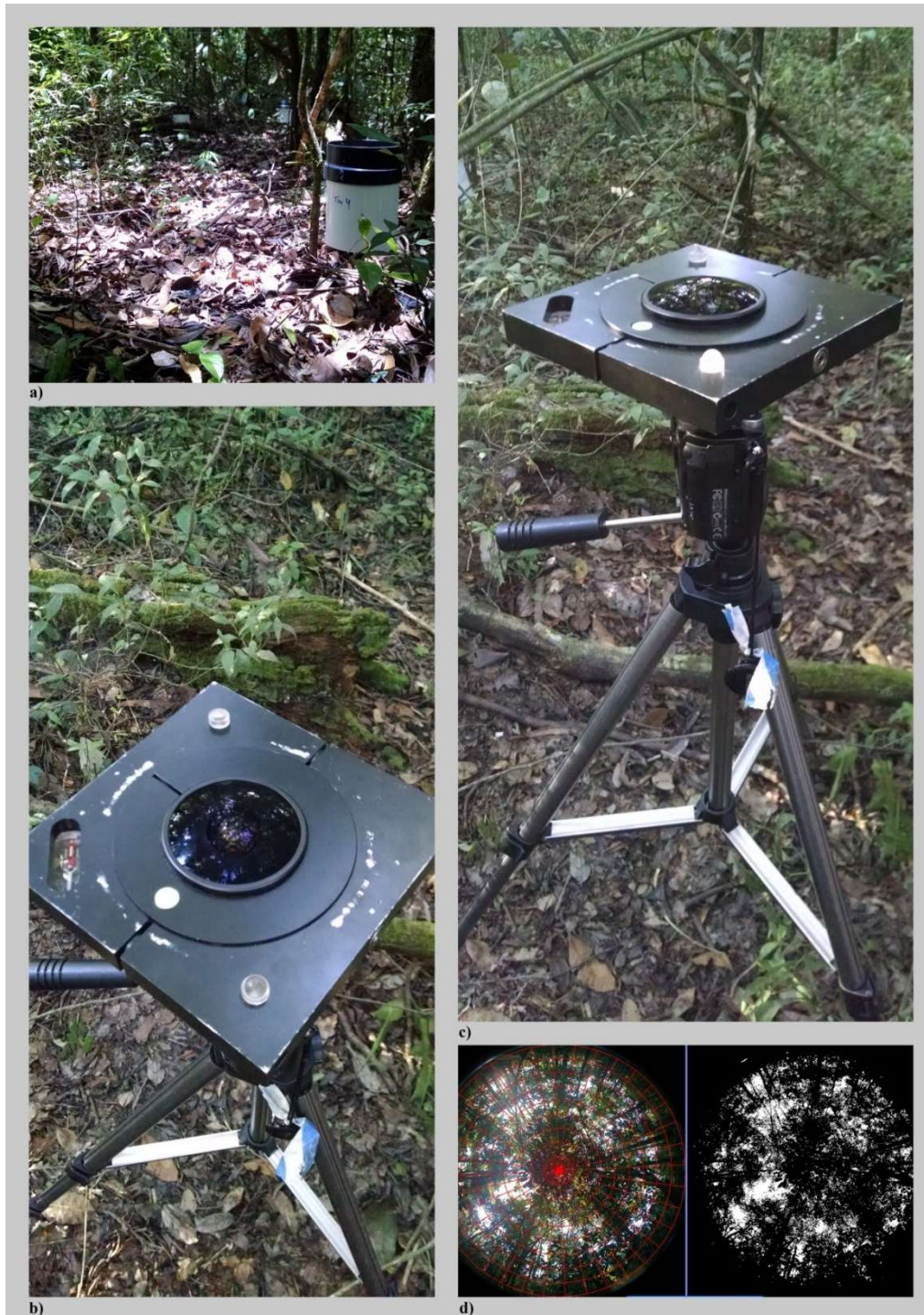
Figura 4.10 - Visão geral dos equipamentos utilizados. a) pluviógrafos de bscula instalados na rea; b) detalhe da lente 180°; c) arranjo do conjunto cmera, lente e trip; d) imagem registrada em processamento.
