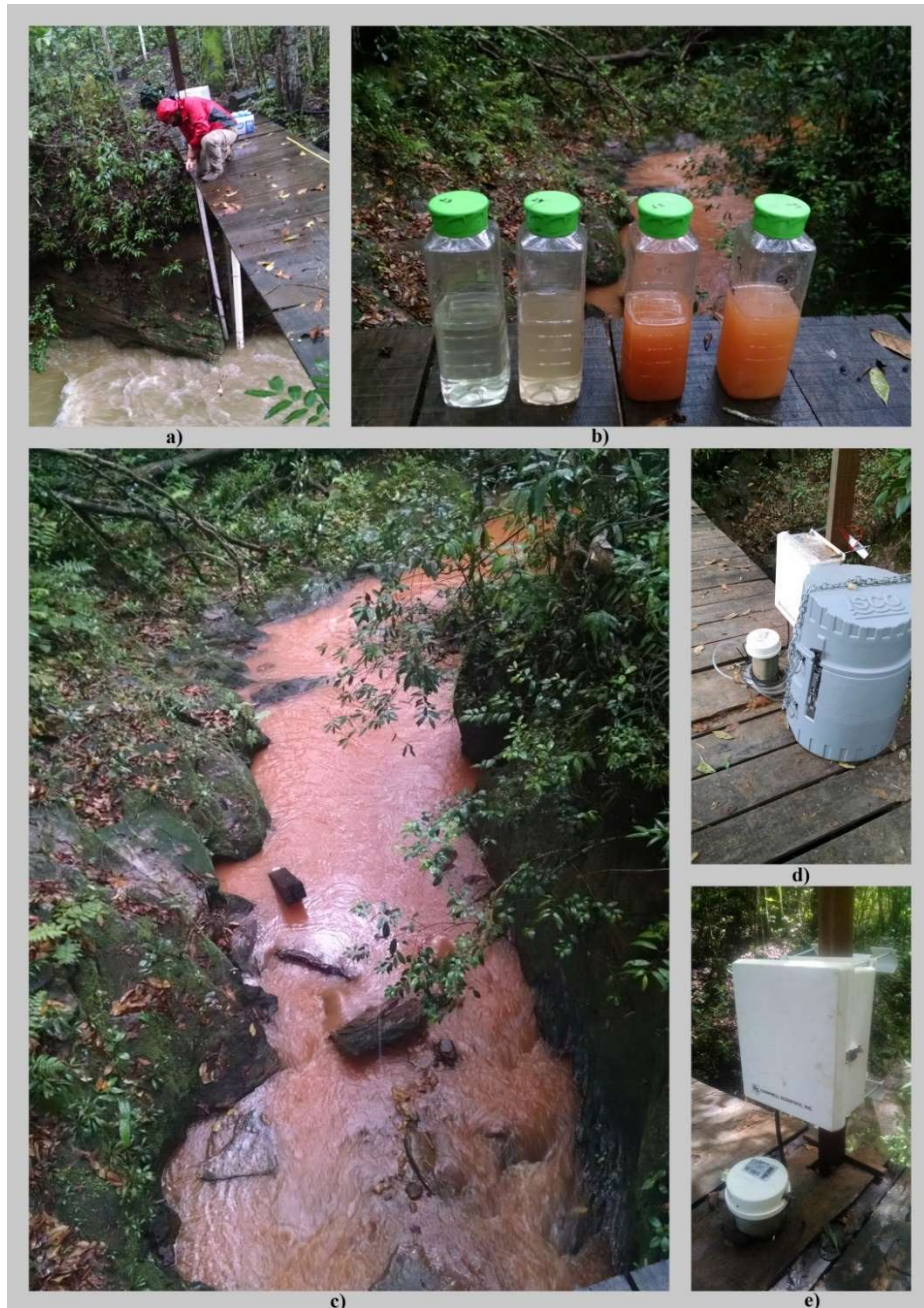
Figura 4.5 - Monitoramento de qualidade. a) amostragem na vertical central; b) amostras coletadas; c) corpo hídrico durante evento; d) amostrador automático; e) local de instalação da sonda multiparamétrica.
