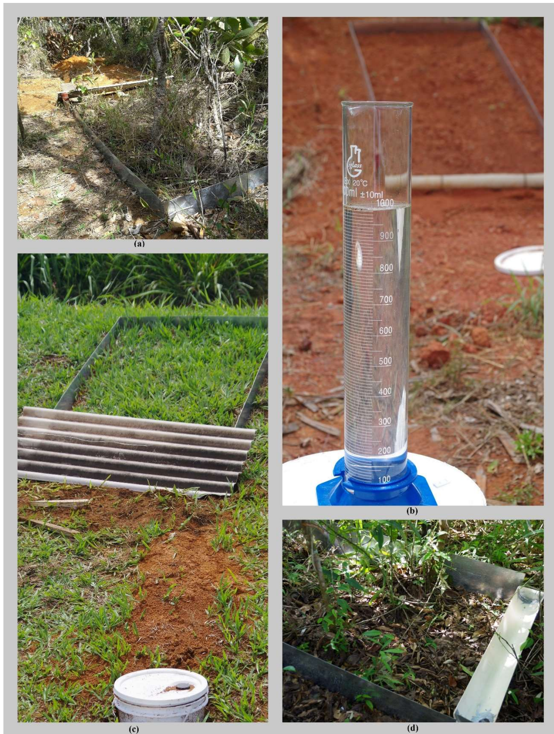
Figura 4.13 - Parcelas tipo Wischmeier. a) cerrado sentido restrito; b) solo exposto; c) gramínea; e d) mata de galeria.
