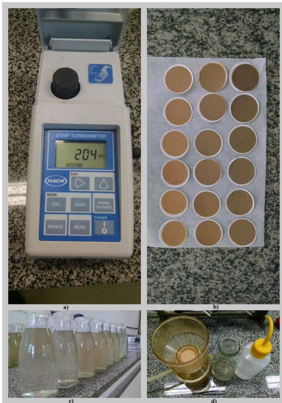
Figura 4.6 - Equipamentos utilizados na determinação dos sólidos em suspensão. a) turbidímetro de bancada; b) amostras secas para determinação da massa; c) amostras brutas; e d) sistema de filtração.
