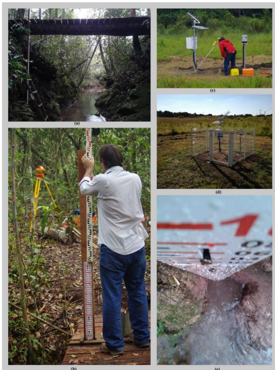
Figura 4.3 - Seção hidrométrica do córrego Capetinga. a) visão da seção; b) nivelamento de régua; c) instalação da PCD; d) PCD finalizada; e e) régua linimétrica.
