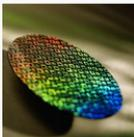
Finalmente, a sétima e, talvez, mais importante aplicação da física de plasmas é a produção de "wafers" de silício cobertos por transistores. Bombardeia-se o wafer com os íons presentes no plasma, de maneira que ele desgaste lentamente o material, para produzir camadas ultra finas. Esse processo, chamado sputtering, é essencial para a produção de computadores cada vez menores e mais baratos.
