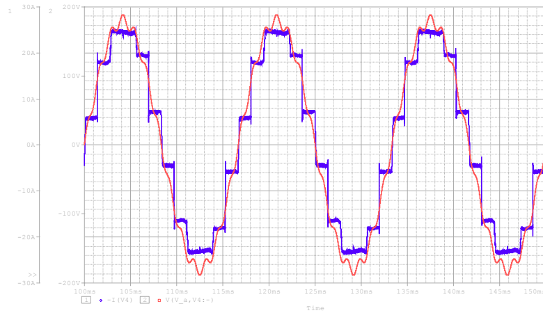
Figura 4.29 – Tensão v_{an} , fase-neutro e corrente i_{a(in)} de alimentação CA.
