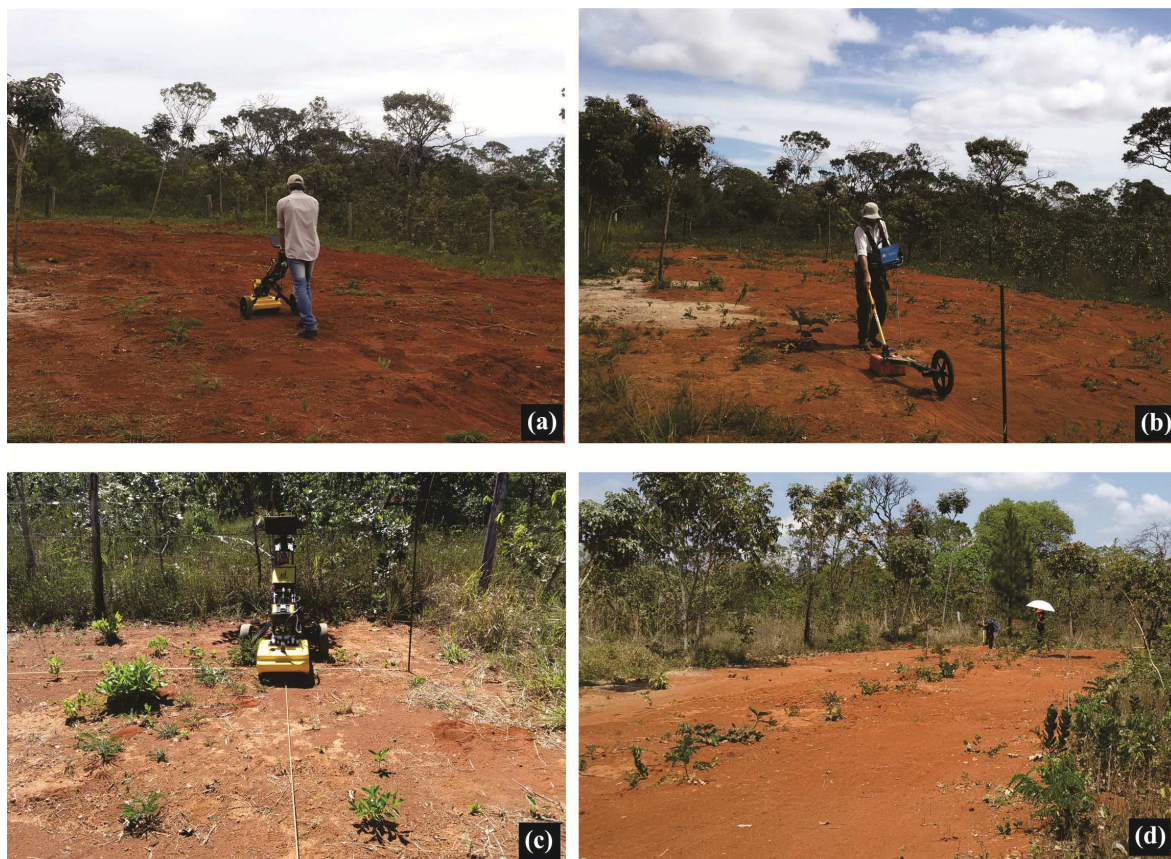
Figura 4.9 – Fotos das aquisições dos radargramas na área do SCGF-UnB, após o sepultamento dos alvos. Aquisições com as antenas de 250 MHz, 700 MHz (a) e 400 MHz (b), no período de precipitação. E aquisição com as antenas de 250, 700 MHz (c) e 400 MHz (d), no período de estiagem.
