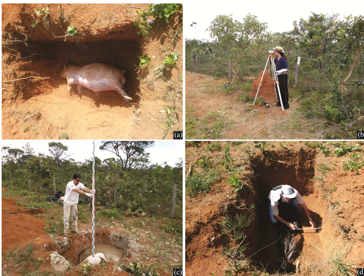
Figura 2.10 – (a) Posição da carcaça de suíno na cova. (b) e (c) Registro da profundidade do alvo com equipamentos topográficos. (d) Medição distância alvo-parede da cova.
