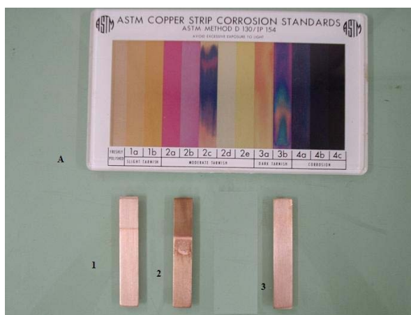
Figura 27 – Teste de corrosão ao cobre. A) Padrão ASTM de corrosão das placas de cobre; 1) borra de soja; 2) gordura de frango; 3) sebo de boi.
