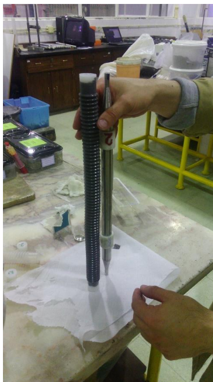
Figura 76 - Tubo corrugado preenchido com argamassa, pronto para o ensaio de deformação autógena segundo ASTM C1698
