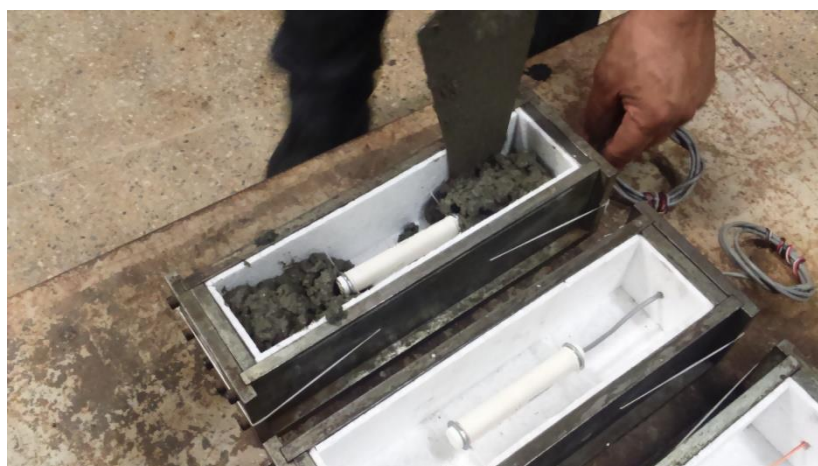
Figura 83 - Moldagem do corpo-de-prova com extensômetro embutido
