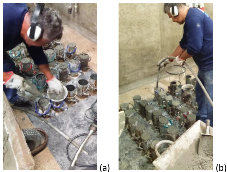
Figura 67 - Enchimento das formas cilíndricas 10x20 cm (a) e adensamento com vibrador de agulha de imersão (b)
