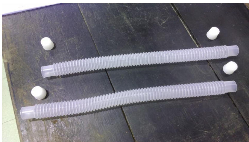
Figura 75 – Conjunto de tubos corrugados e tampas utilizados como moldes para determinação da deformação autógena segundo a ASTM C1698
