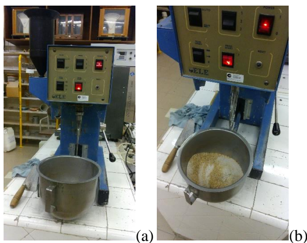
Figura 63 - Misturador utilizado na produção das argamassas (a) com detalhe dos materiais na cuba (b)
