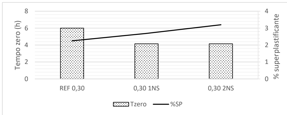
Figura 107 - Tempo zero e teor de aditivo superplastificante dos traços de concreto com e sem adição de nanossílica
