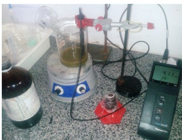
FIGURA 16. Determinação experimental do pH do substrato. Fonte: Autor.
