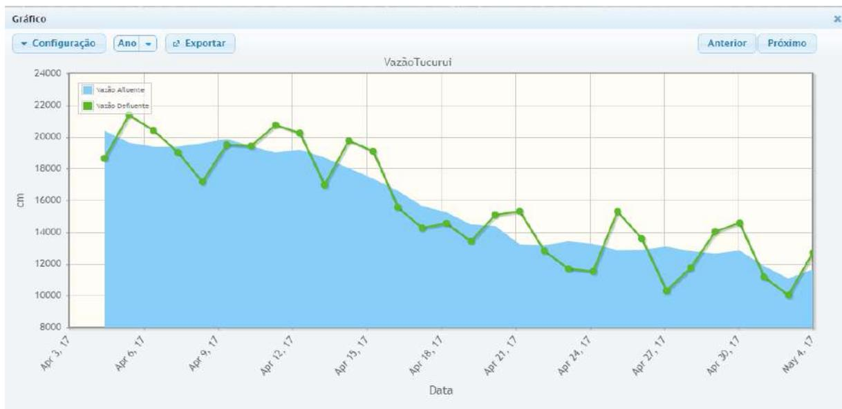
Figura 6. Gráfico com a plotagem da vazão afluente (em azul) e defluente (linha verde) da UHE Tucuruí.
