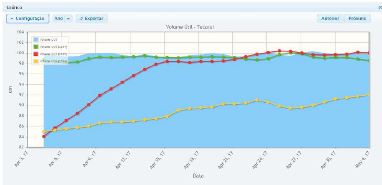
Figura 5. Gráfico com a plotagem do volume útil da UHE Tucuruí para um período de sete dias.
