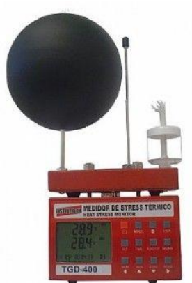
Figura 3.15 – Medidor de stress térmico TDG-400 Instrument (Função: medição de stress térmico).
