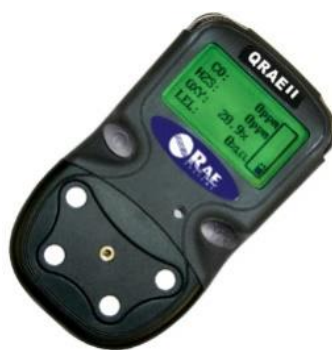
Figura 3.13 – Multidetector de gás RAE® QRAEII (Função: análise de gases).
