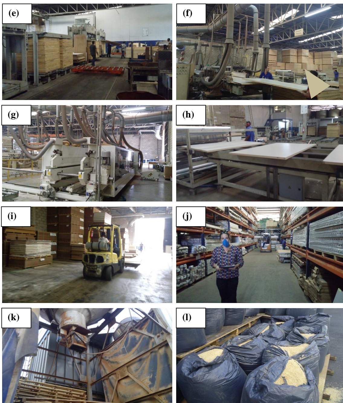
Figura 3.4 (continuação) – Etapas do processo produtivo: (c) pintura com forno eletrostático; (d) montagem de divisórias; (e) prensa hidráulica; (f) serragem de precisão para acabamento; (g) maquina de cortes especiais; (h) máquina de embalagem de produtos acabados; (i) empilhadeira transportando insumos produtivos; (j) almoxarifado de produtos acabados, (k) silos de pó de serragem; (l) armazenamento de pós de serragem.
