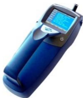
Figura 3.17 – Medidor de partículas em dispersão TSI DustTrack (Função: medição de partículas em dispersão).
