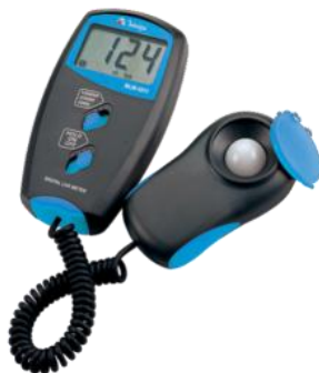
Figura 3.16 – Luxímetro Minipa MLM-1011 (Função: medição de iluminância).
