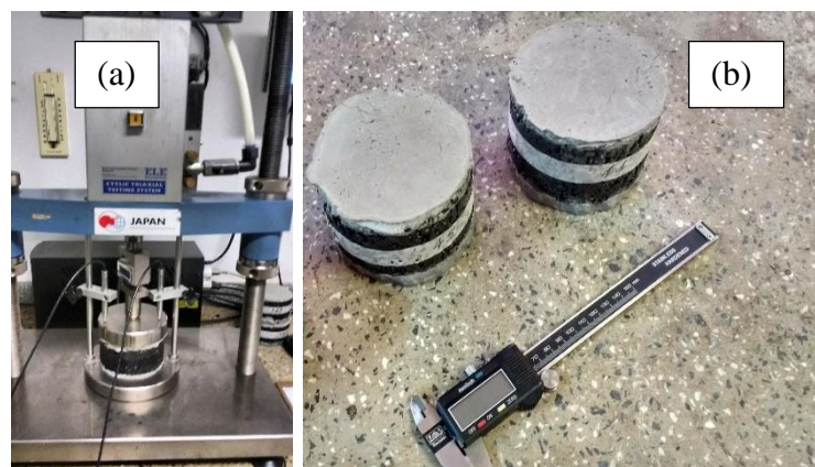
Figura 3.27 Ensaio creep estático: (a) Equipamento de ensaio; (b) corpos de prova.
