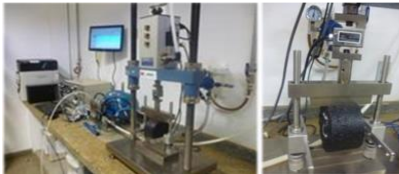
Figura 3.31 Sequência do ensaio de vida de fadiga por compressão diametral.
