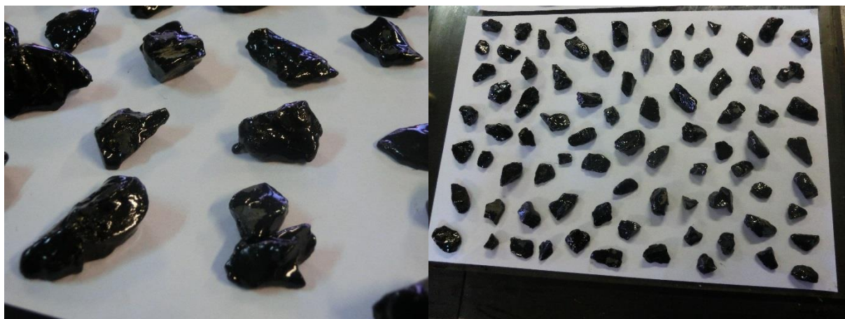
Figura 4.6 Ensaio de adesividade do ligante asfáltico modificado ao agregado graúdo.
