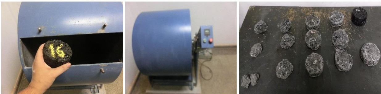
Figura 3.33 Sequência do ensaio de abrasão Cântabro.
