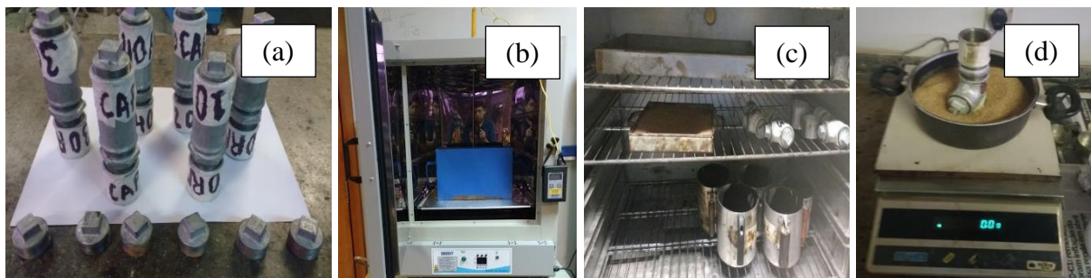
Figura 3.8 Sequência do ensaio de estabilidade ao armazenamento de asfalto: (a) Recipientes adaptados do ensaio; (b) Calibração da caixa de areia – controle de temperatura; (c) aquecimento dos materiais; (d) Peso do asfalto modificado.
