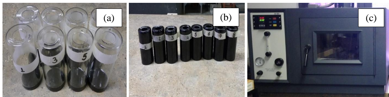
Figura 3.9 Ensaio de envelhecimento a curto prazo RTFOT: (a) Frascos antes do ensaio; (b) Frascos após o ensaio; (c) Estufa de envelhecimento a curto prazo.
