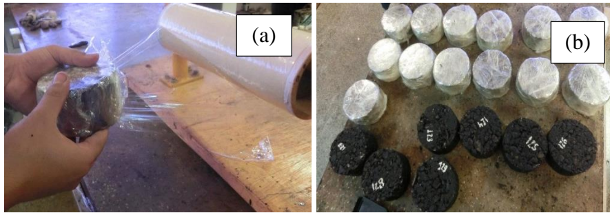
Figura 3.20 Determinação da densidade aparente: (a) colocação do filme de PVC no corpo de prova; (b) corpos de prova com e sem filme de PVC.
