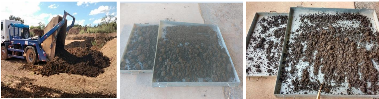
Figura 3.4. Resíduos de lodos de ETA: (a) disposição final; (b) secagem inicial ao ar; (c) secagem final ao ar.
