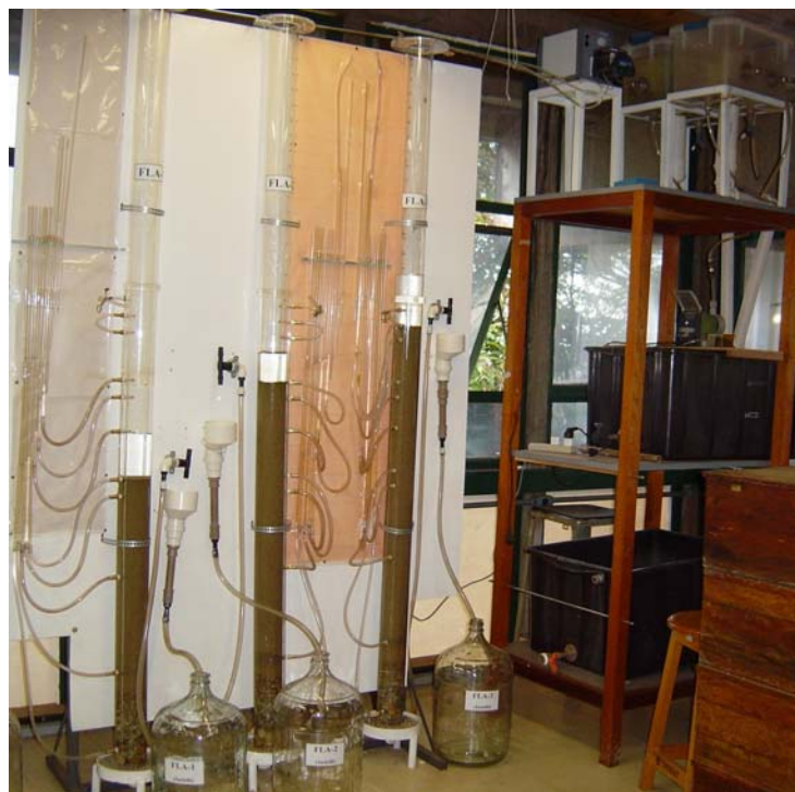
Figura 4.3 – Fotografia dos filtros lentos com profundidades diferentes da camada de areia, durante a etapa experimental 2.
