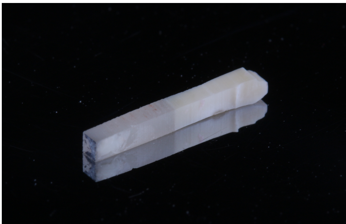
Figura 28 – Palito dentina-resina para teste de microtração.
