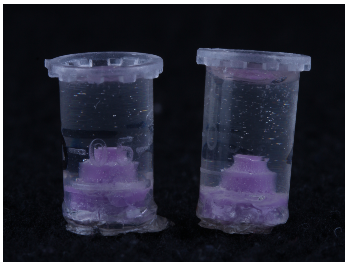
Figura 10. Moldes vazados com resina epóxica
