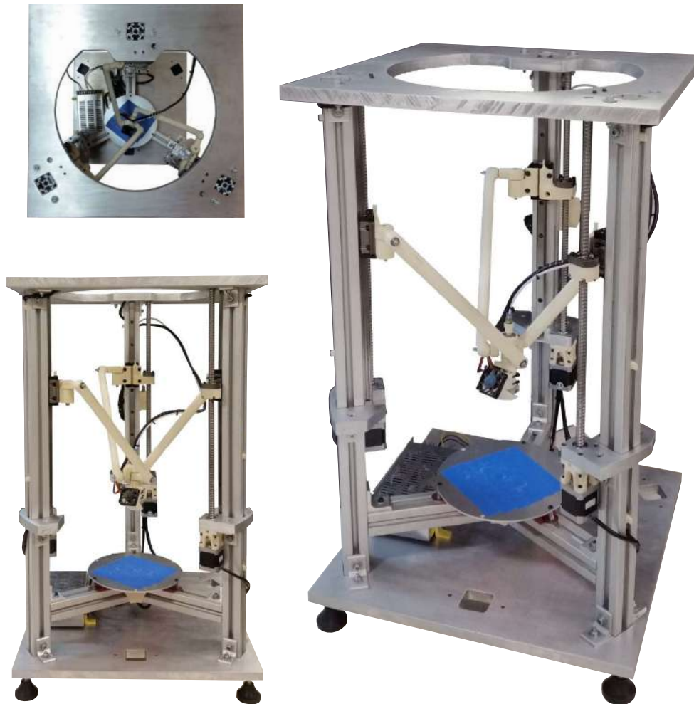
Figura 6.1: Protótipo funcional do rDL-AM com estrutura de alumínio. Fonte: autor.
