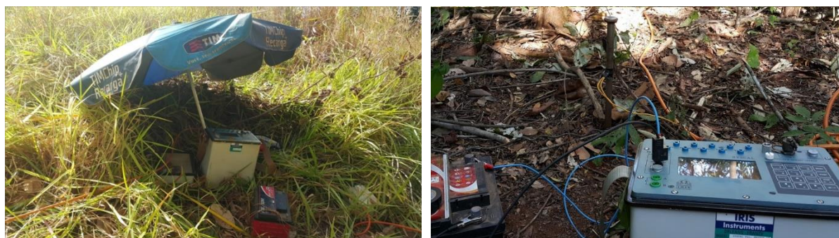
Figura 2.3 – Fotografias evidenciam a aquisição de dados de eletrorresistividade com o equipamento SYSCAL PRO em campo.
