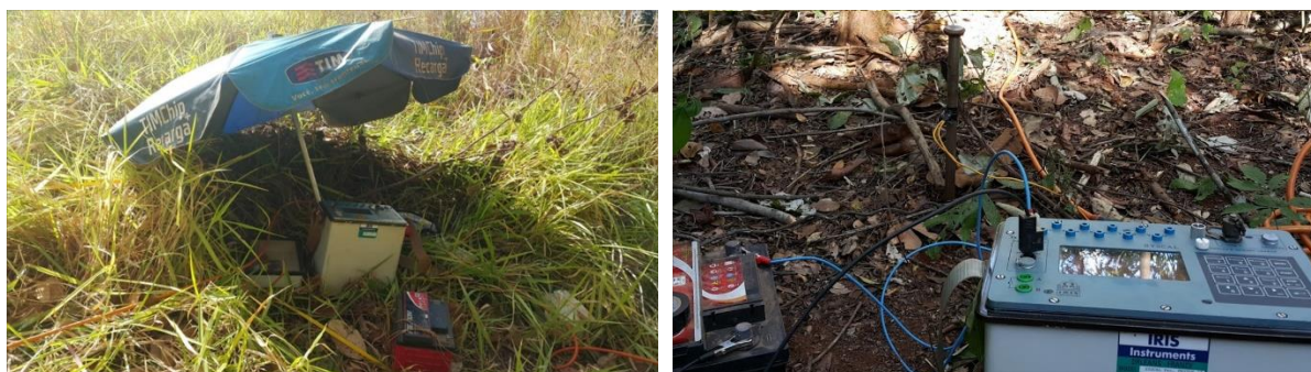
Figura 3.5 – Fotografias evidenciam a aquisição de dados de eletrorresistividade com o equipamento SYSCAL PRO em campo.
