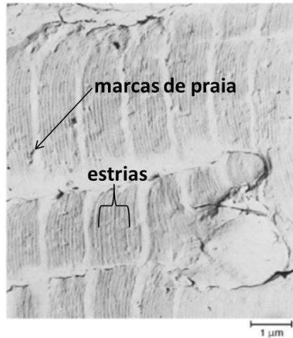
Figura 2.5 - Superfície de fratura num alumínio 7075-T6 (modificado de Halford, 2006)
