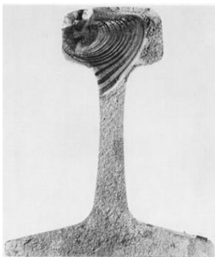
Figura 2.6- Macrografia de um trilho de trem que falhou por fadiga (fonte: ASM Metals Handbook- Fractography, 1987).
