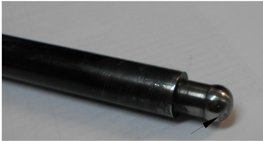
Figura 6.6: Desgaste da ferramenta.
