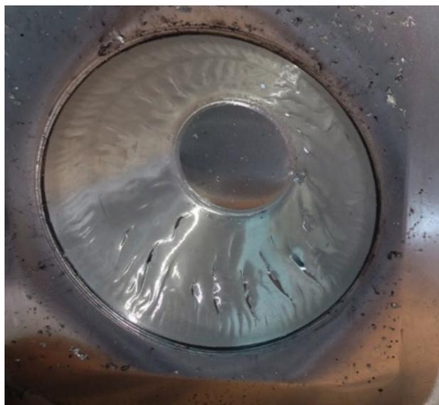
Figura 6.9: Resultado da conformação da peça utilizando 2ml de óleo lubrificante
