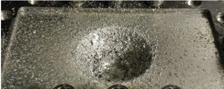
Figura 5.16: Erro de processamento com parâmetros  $A_p$  0.6 mm, S6000 RPM e F3600 mm/min
