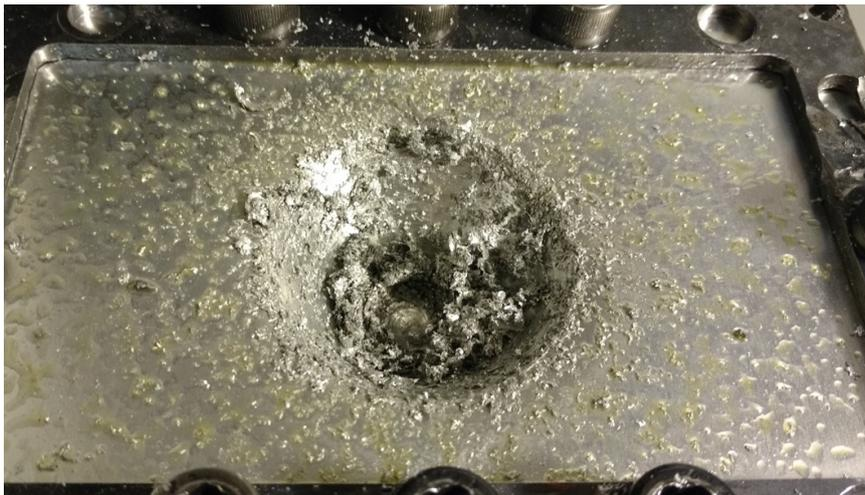
Figura 5.17: Erro de processamento com parâmetros  $A_p$  1.4 mm, S3000 RPM e F1200 mm/min
