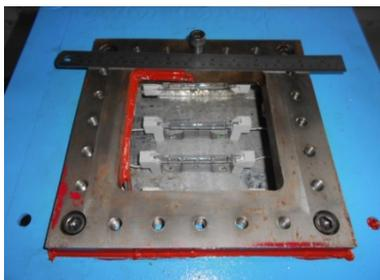
Figura 4.15: Posicionamento do sensor de temperatura no conjunto
