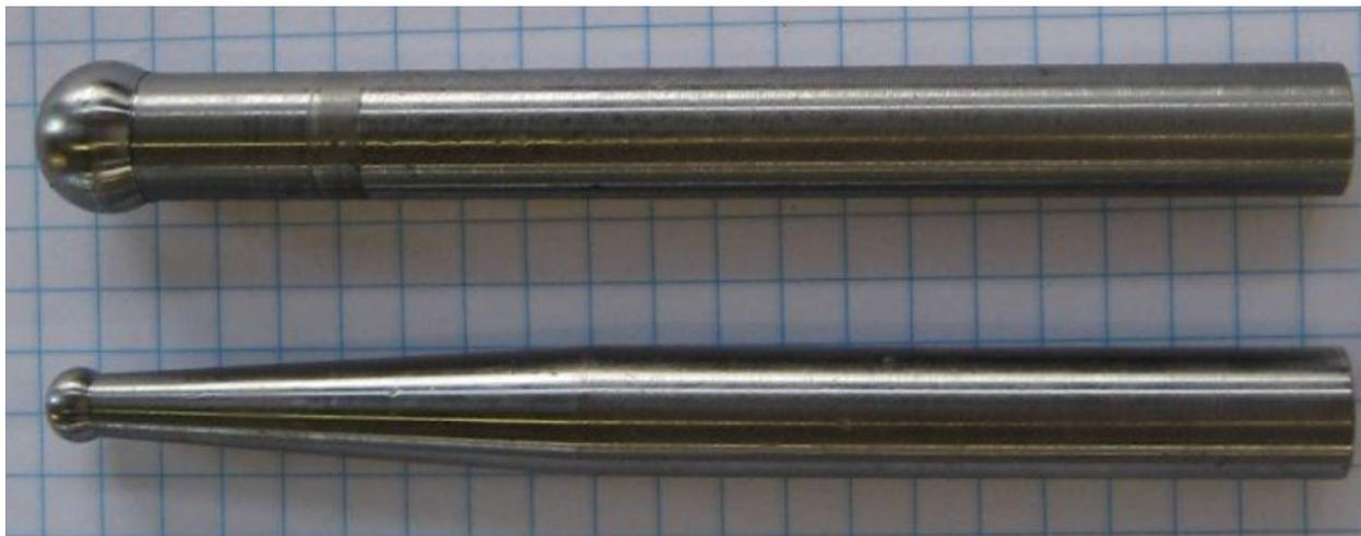
Figura 2.9: Ferramentas de conformação do processo SPIF
