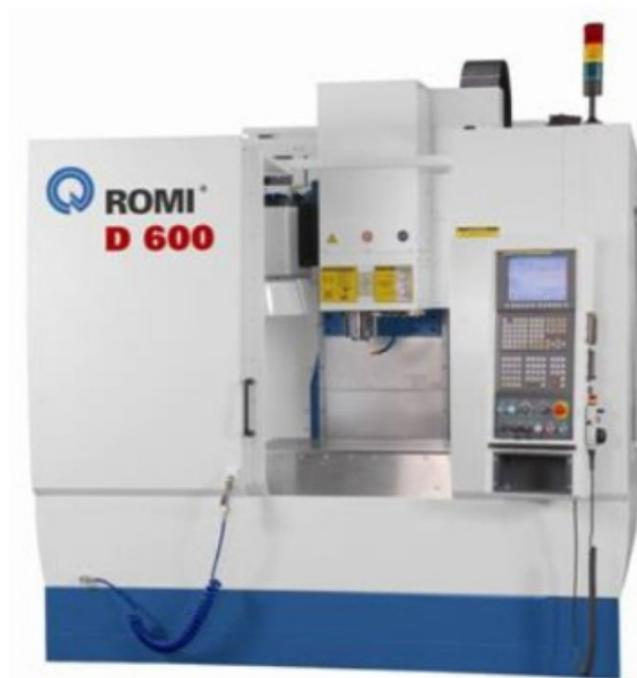
Figura 2.21: Máquina CNC utilizada para SPIF ROMI D600
