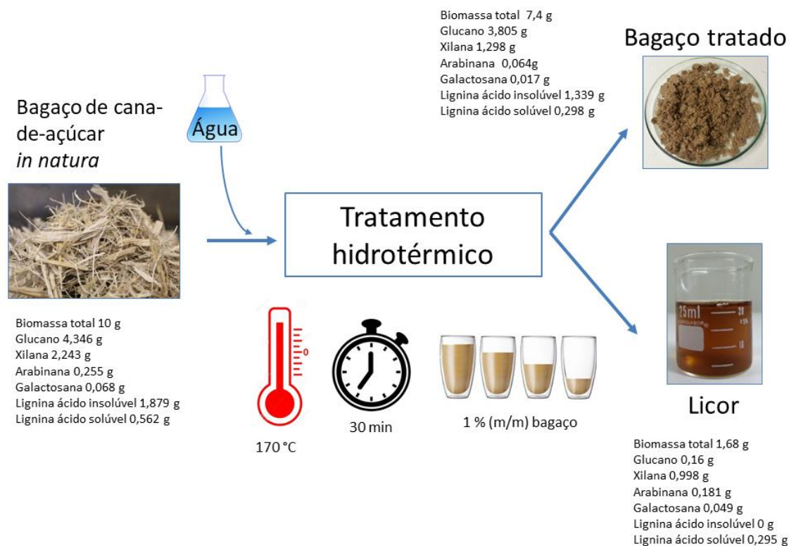
Figura 2. Esquema do tratamento hidrotérmico do bagaço de cana-de-açúcar in natura para obtenção de frações menos recalcitrantes para cultivo de A. niger . O destino dos principais componentes da biomassa in natura é mostrado.
