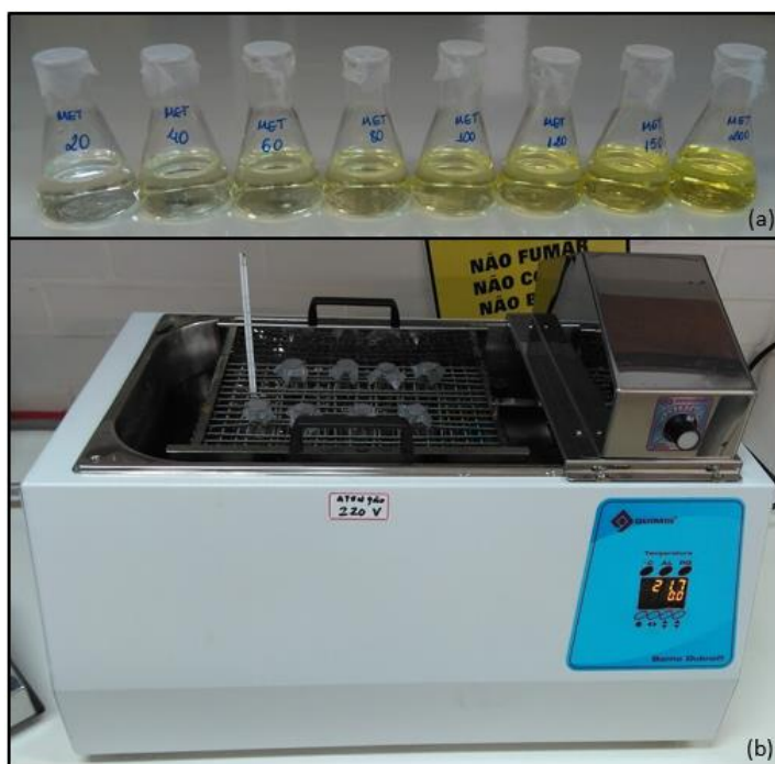
Figura 14: (a) conjunto de erlenmeyers contendo soluções de Cr(VI); (b) equipamento Banho Dubnoff com conjunto de erlenmeyers e termômetro.
