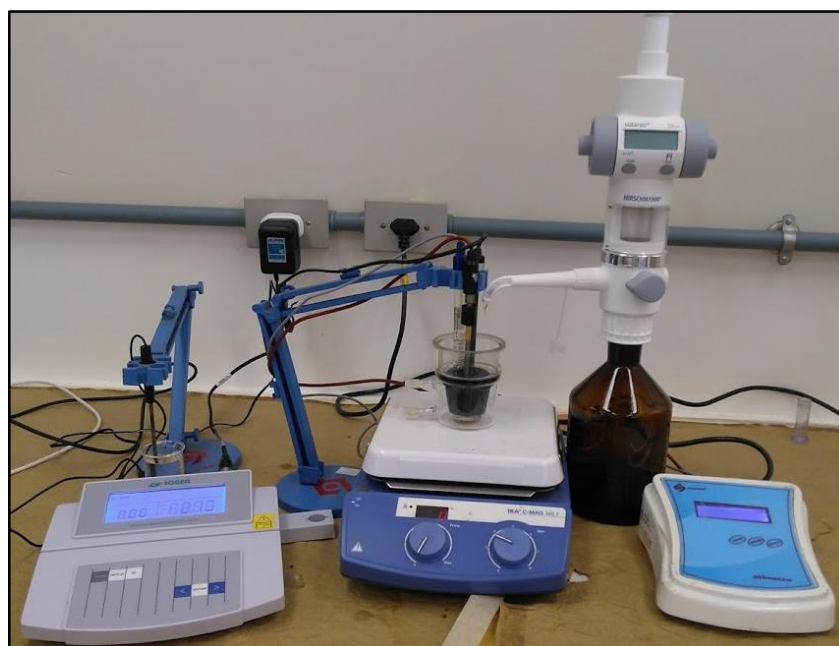
Figura 10: Esquema geral da titulação pelo Método Potenciométrico- Conduítmétrico (MPC).
