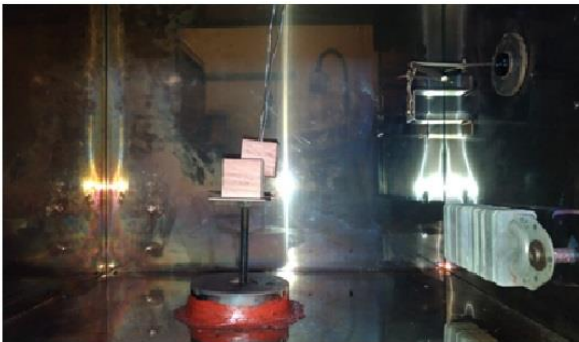
Figura 3.6 Posicionamento dos dois corpos de prova no interior do reator
