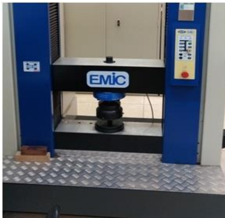
Figura 3.7 Máquina universal de ensaios – EMIC DL30000.
