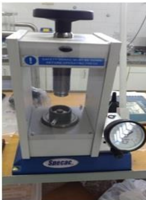
Figura 3.10. Fabricação de pellet para ensaio de determinação de poder calorífico
