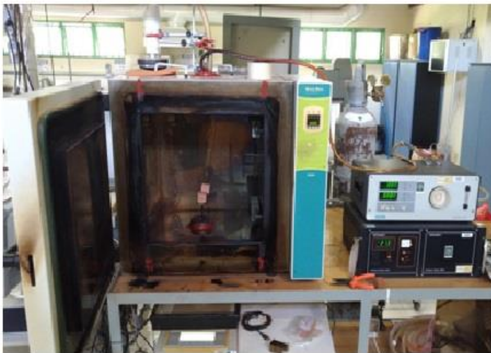
Figura 3.2 Reator de torrefação instalado na área de energia do LPF
