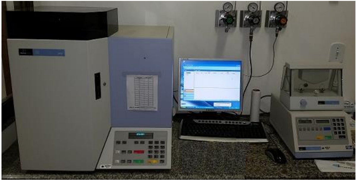
Figura 3.8 Analisador elementar CHNS da marca Perkin Elmer modelo EA 2400 series II, localizado no Instituto de Química da UnB.
