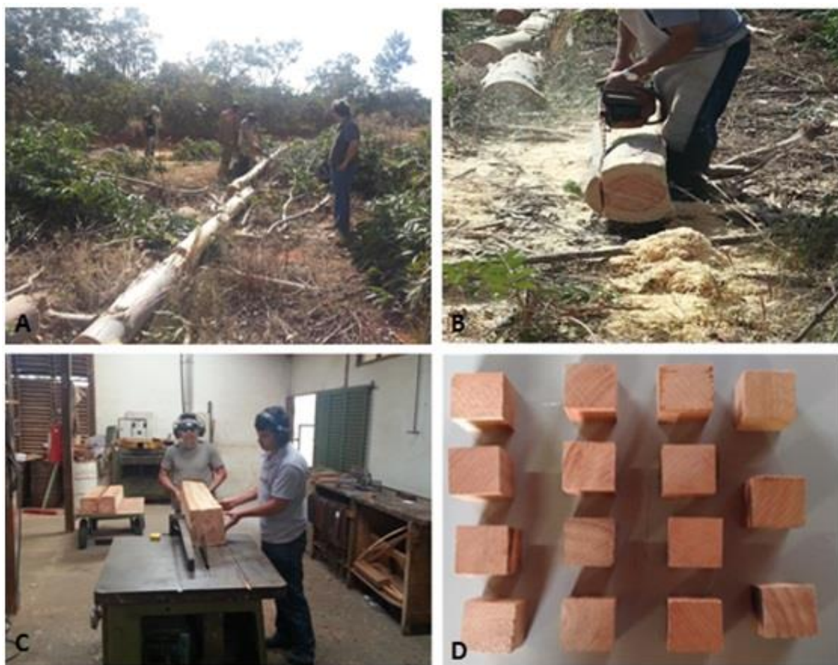
Figura 3.1 Preparo dos corpos de prova. A) abate da espécie Eucalyptus grandis na FAL. B) retirada das costaneiras e formação de bloco. C) desdobro da madeira na carpintaria do LPF. D) Amostras confeccionadas em formato cúbico 3 x 3 x 3cm.
