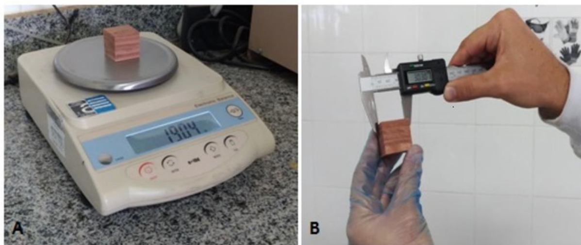
Figura 3.4 Determinação da densidade aparente da amostra. A) Verificação da massa do corpo de prova. B) Medição do volume com paquímetro digital.
