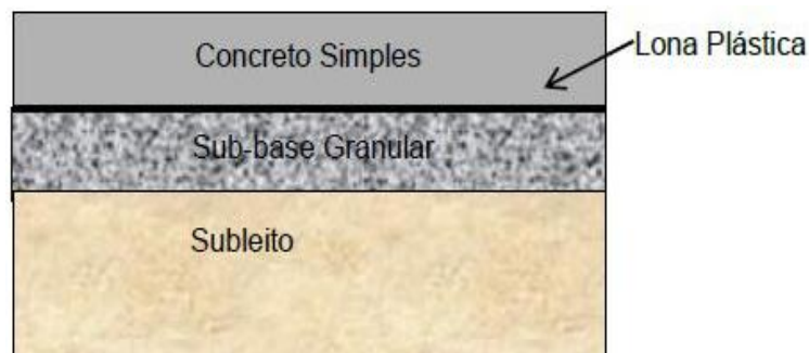
Figura 2.9: Estrutura de Pavimento rígido de ciclovia Fonte: Maranhão (2014)
