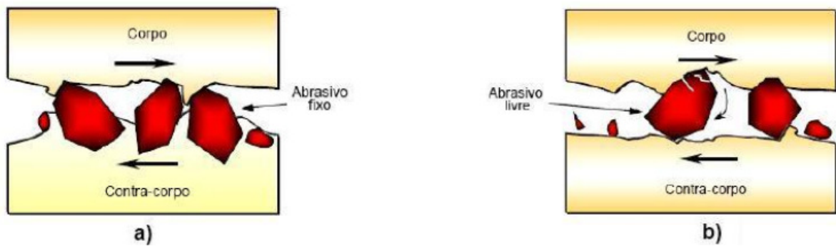
Figura 3.18 - Representação esquemática: a) desgaste abrasivo por deslizamento de partículas e b) desgaste abrasivo por rolamento de partículas.
