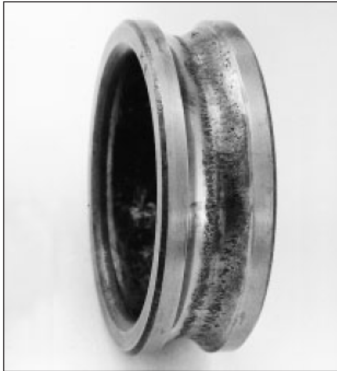
Figura 2.10 – Dano por fadiga na pista interna de rolamento. (Fag, Rolling Bearing Damage, 2001.)
