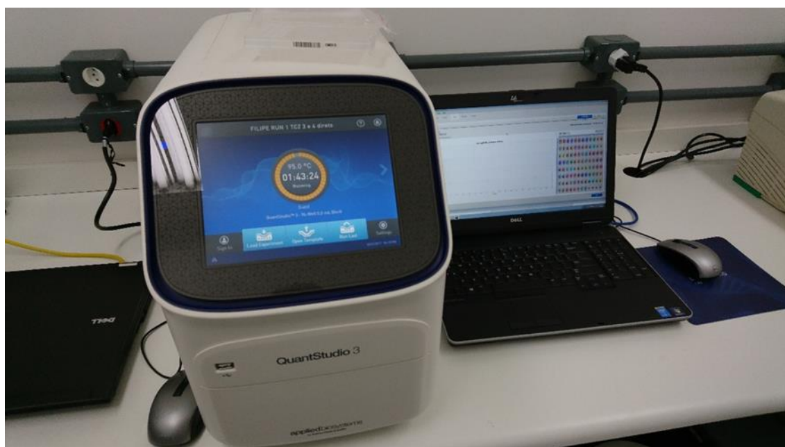
Figura 10: Máquina utilizada para realização da leitura dos exames de qPCR. Fabricante: ThermoFisher Scientific Modelo: Applied Biosystems QuantStudio 3 Real-Time PCR System
