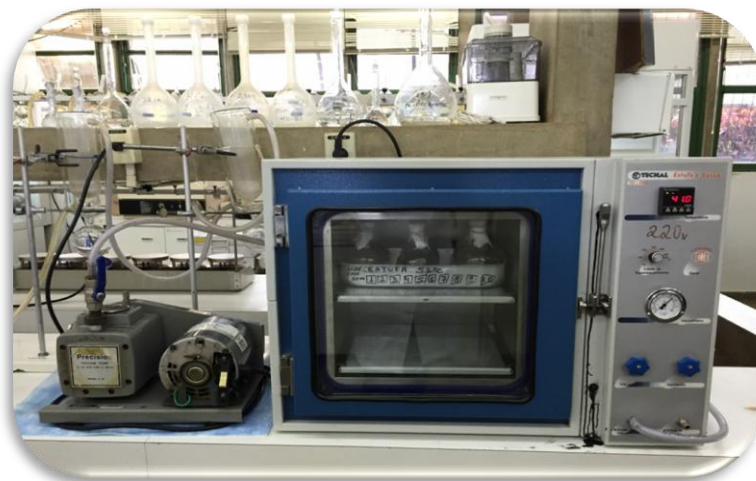
Figura 5. 7. Balões com o EMB na estufa a vácuo para evaporação completa do metanol. Foto: Autor.
