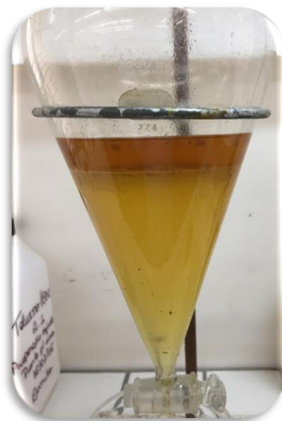
Figura 5. 11. Formação de emulsão durante a separação com o diclorometano. Foto: Autor.
