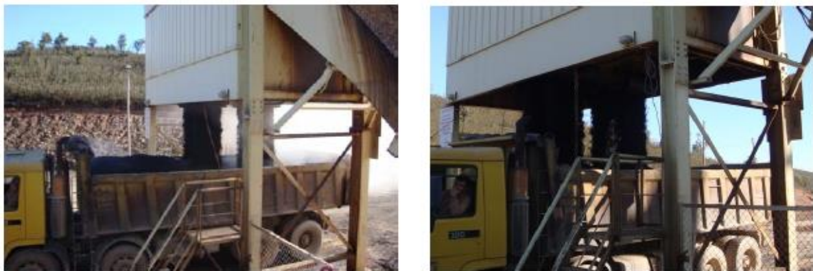
Figura 2.2 - Diferença nas emissões de fumos e gases durante descarregamento, no caminhão, de misturas asfálticas a quente (à esquerda) e morna (à direita) (FERREIRA et al. , 2009)
