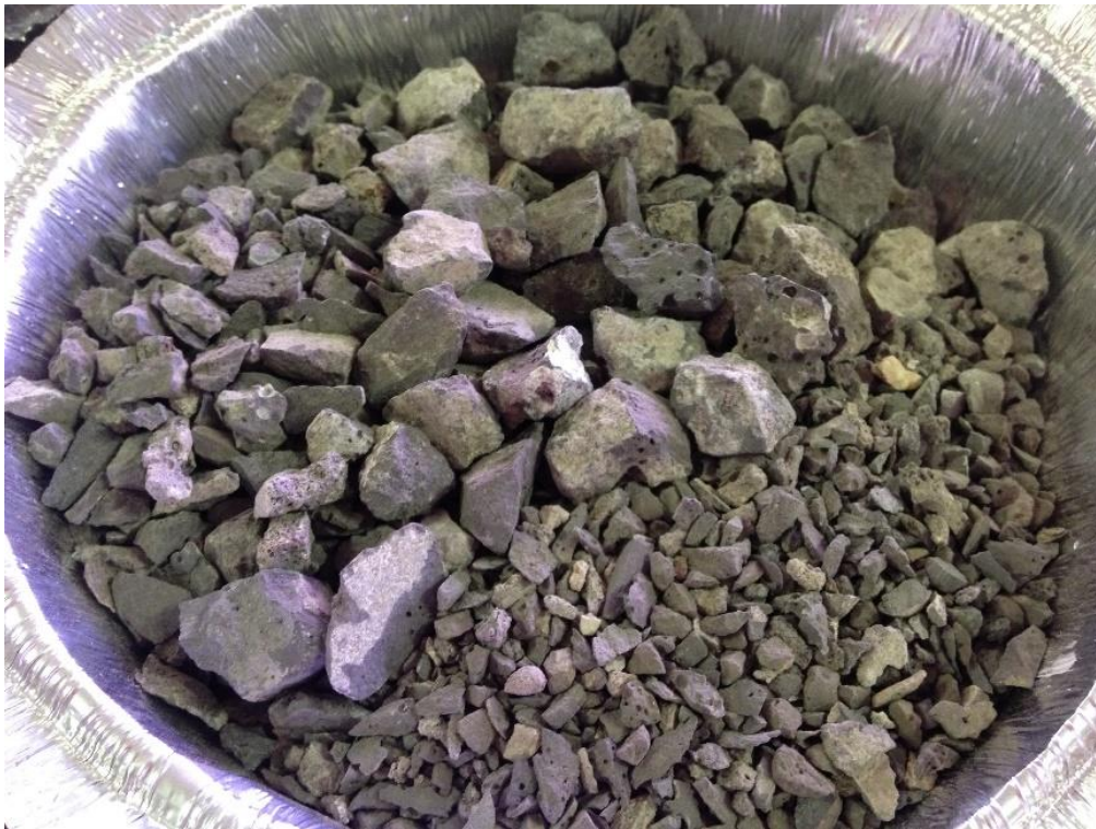
Figura 4.2 – Aspecto superficial das partículas de escória de aciaria
