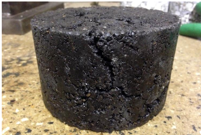
Figura 4.29 – Amostra com trinca devido à expansão
