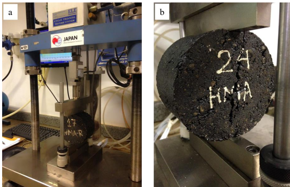
Figura 3.11 - a) Ensaio de fadiga; b) amostra em ruptura por fadiga
