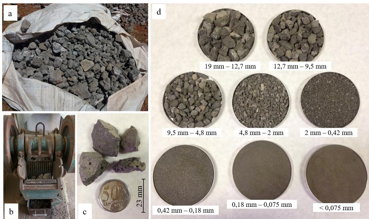
Figura 3.3 - Escória de aciaria: a) disposta ao ar livre; b) durante o processo de britagem; c) em detalhe na sua forma final; d) peneirada para composição da curva granulométrica
