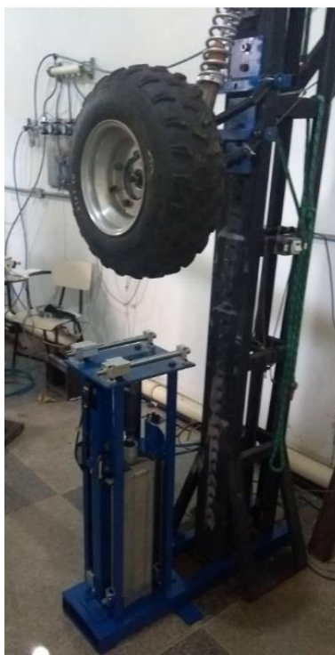
Figura 73. Bancada de simulação de sistemas de suspensão. Fonte: Autor
