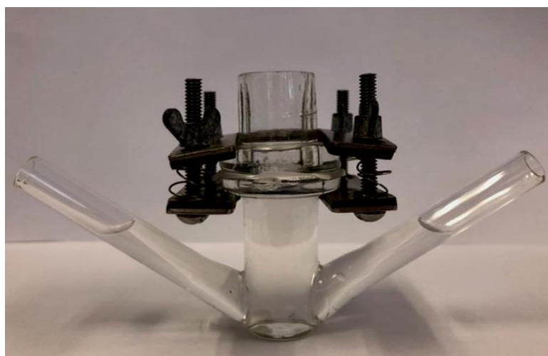
Figura 12 Modelo de célula de Franz vertical do tipo modificada
