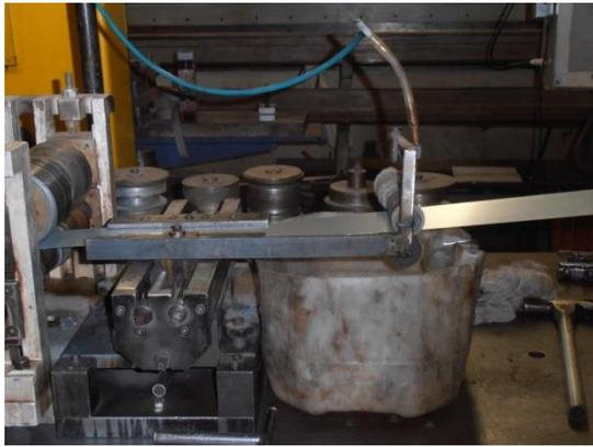
Figura 16. Detalhe do processo de perfilamento.
