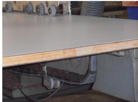
Figura 13. Refilamento de bordas da divisória
