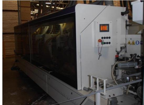
Figura 23. Centro de usinagem CNC (corte, colagem de bordas PS)
