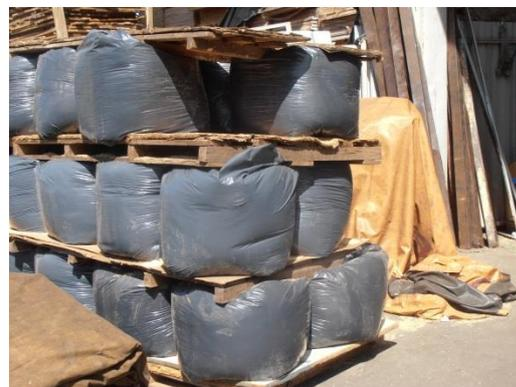
Figura 27. Resíduos coletados resultante do corte de painéis - cavaco
