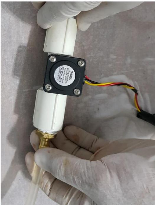
Figura 15: Sensor de fluxo, utilizado para medir o fluxo de líquido infundido no coração suíno. (GALOTE, 2018).
