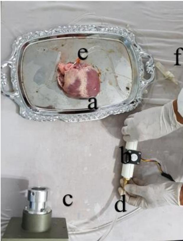
Figura 14: Sistema com Coração Suíno, onde: (a) coração suíno; (b) sensor de fluxo; (c) equipamento desenvolvido; (d) tubos para a passagem do fluxo; (e) cateter intravenoso; (f) equipo.
