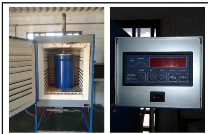
**Figura 5.4.** Forno pirolisador com sistemas de saída de gases e óleo (a); termostato digital (b).
