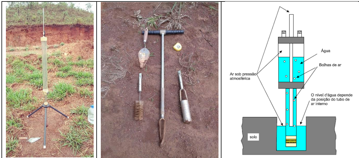
Figura 2.8: Da esquerda para direita: Permeômetro Guelph instalado em campo (Acervo pessoal). Trados que acompanham o equipamento para a perfuração do solo (Acervo pessoal). Esquema de funcionamento de um Permeômetro Guelph (Retirado de SANTOS, 2005).
