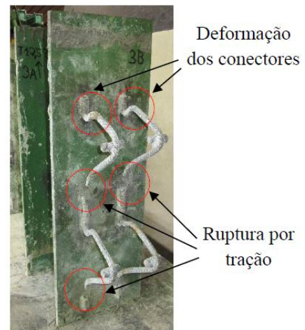
(b) Modelo com conector treliçado, com diâmetro de 12,5 mm
