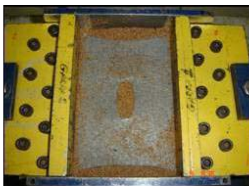
Final do ensaio (deformação \cong 20%)
