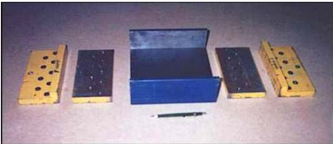
Figura 3.3 – Célula de tração confinada e conjunto de garras recartilhadas (Matheus, 2002).
