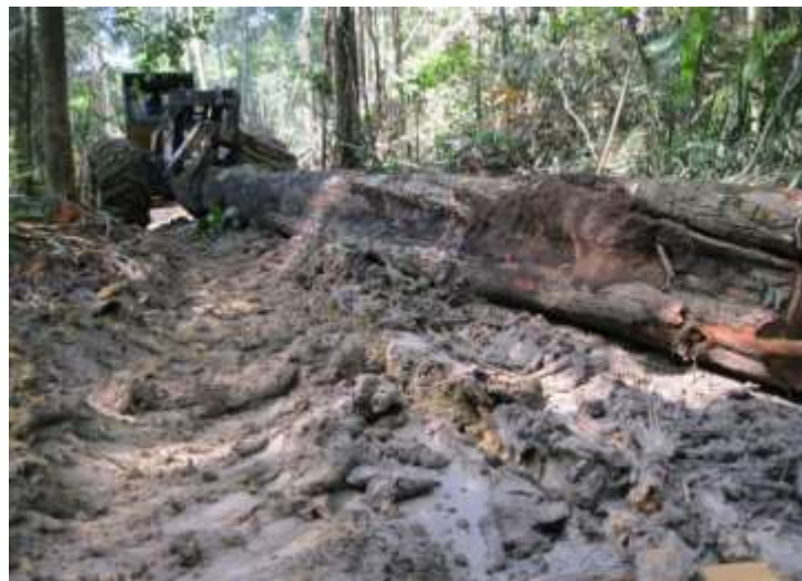
Figura 10 - Arraste de tora utilizando trator skidder : movimentação da tora na trilha de extração.
