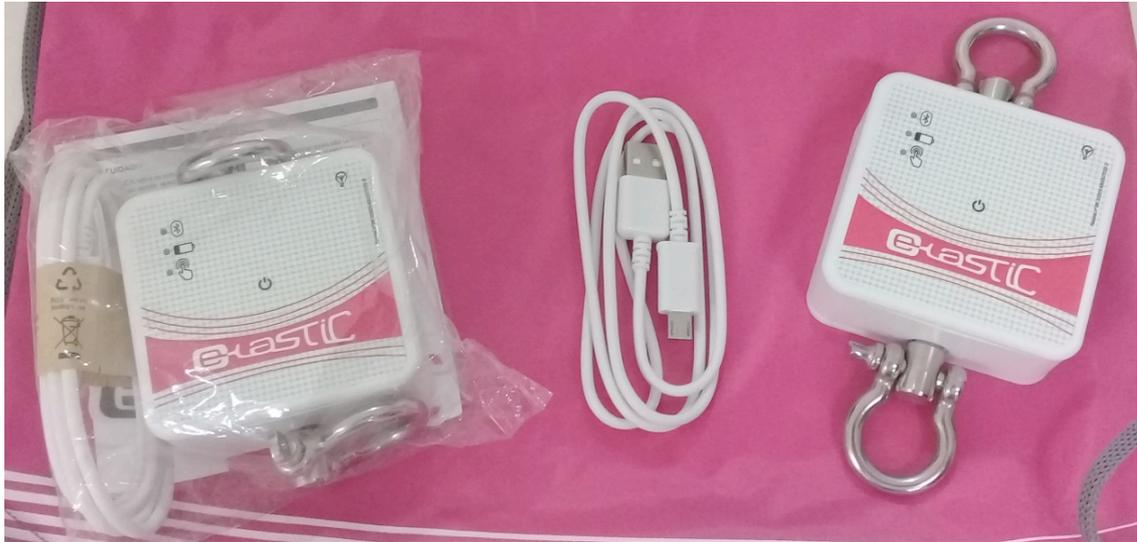
Figura 2 – Célula de Carga
