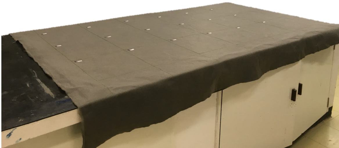
Figura 4.1: Traçado da malha para recorte dos espécimes com 300 x 300mm.
