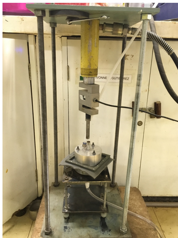
Figura 3.7: Sistema de confinamento de espécimes na célula de BBP.
