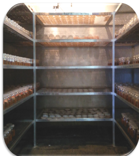
Figura 13. Ensaio de apodrecimento acelerado. Frascos de vidro com as placas suporte das madeiras suscetíveis inoculadas e mantidas em incubadora com temperatura e umidade controladas.
