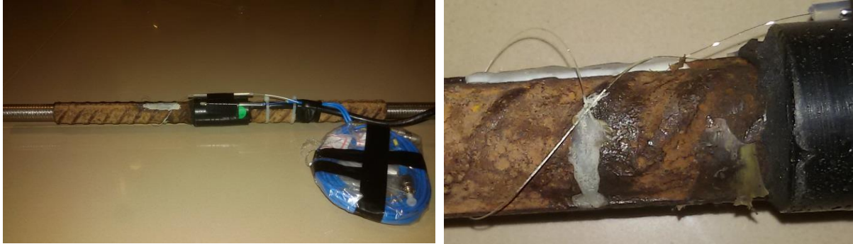
Figura 3.16 – Barra de aço instalada com Strain gages e Fibras sensoras longitudinal e transversal.
