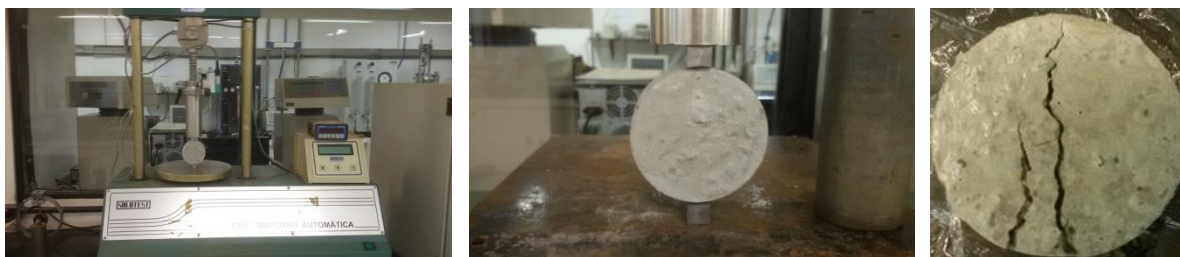
Figura 3.43 – Ensaio de resistência à tração por compressão por compressão diametral.
