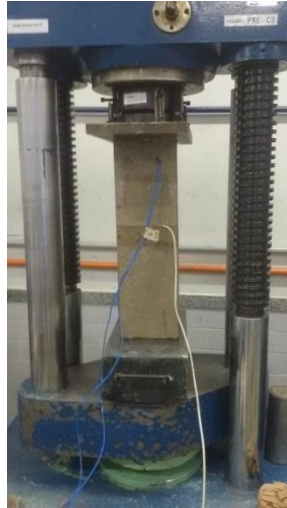
Figura 3.15 – Pilarete 1 montado para ensaio instrumentado com uma Fibra leitura de deformação outra de temperatura (cabos azuis) e strain gages para leitura de deformação (cabo bege).
