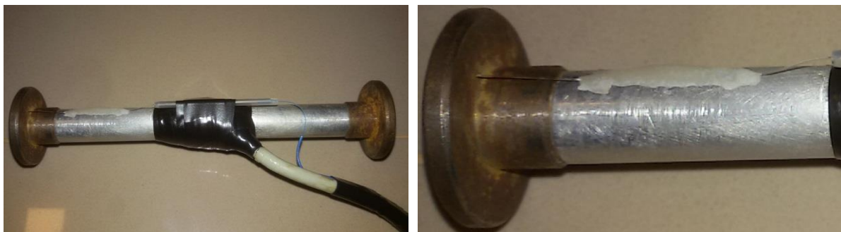
Figura 3.17 – Barra de alumínio instalada com Strain gages e Fibra sensora longitudinal.
