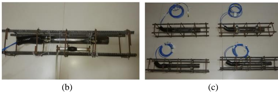
Figura 3.10 – Instalação dos tubos sensores ótico e strain gage nas armações de ferro.
