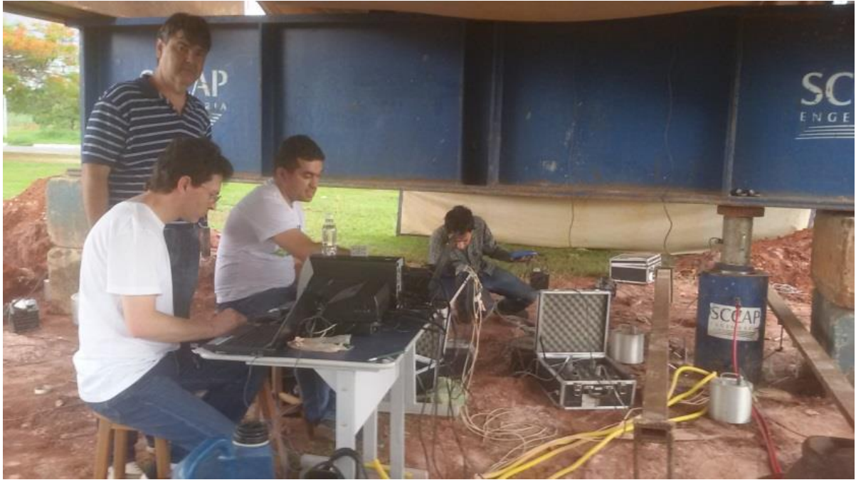
Figura 3.31 – Realização das leituras do sistema ótico e elétrico strain gages durante a prova de carga na estaca 2.
