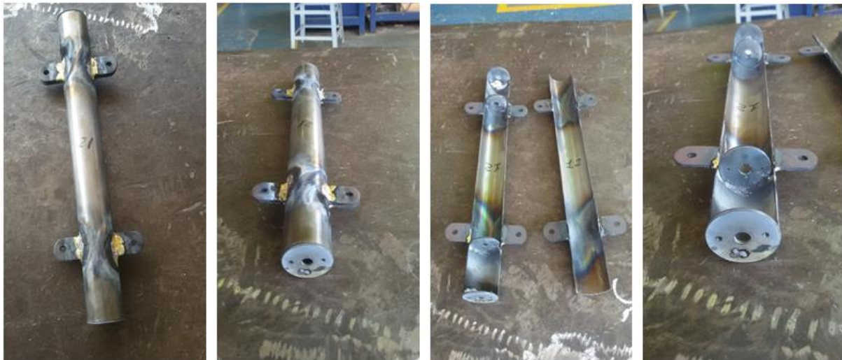
Figura 3.2 (b) - Tubo de proteção da Fibra Ótica com Redes de Bragg.
