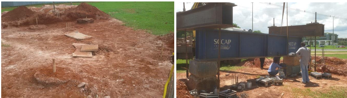
Figura 3.20 – Sistema de reação para prova de carga da estaca instrumentada.
