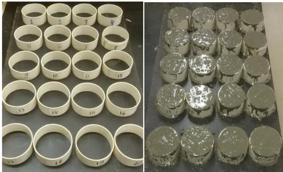
Figura 3.40 – Moldagem dos Corpos de Provas de concreto.
