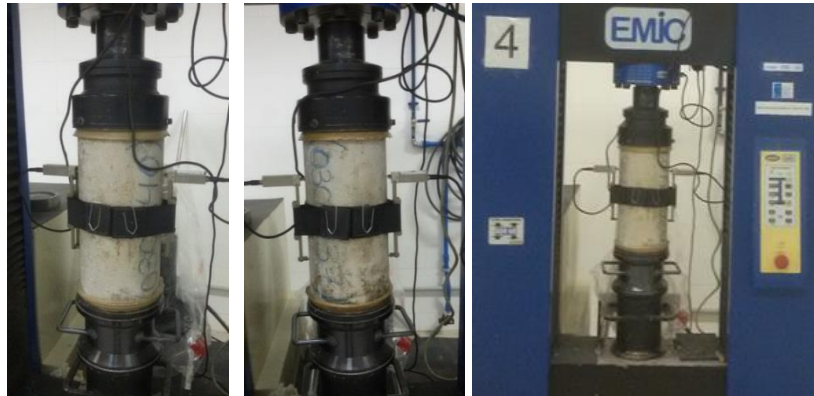
Figura 3.12 - Execução de ensaio de módulo de elasticidade em corpos de prova 15 x 30 cm.
