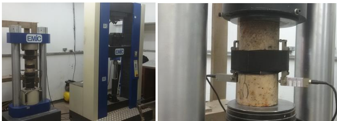
Figura 3.13 – Ensaio de Módulo de Elasticidade dos corpos de provas 10 x 20 cm da Primeira Estaca.
