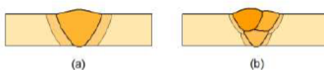
Figura 9. Representação da ZF e ZTA com: a) um passe b) vários passes. Fonte: Modenesi et al, 2012.
