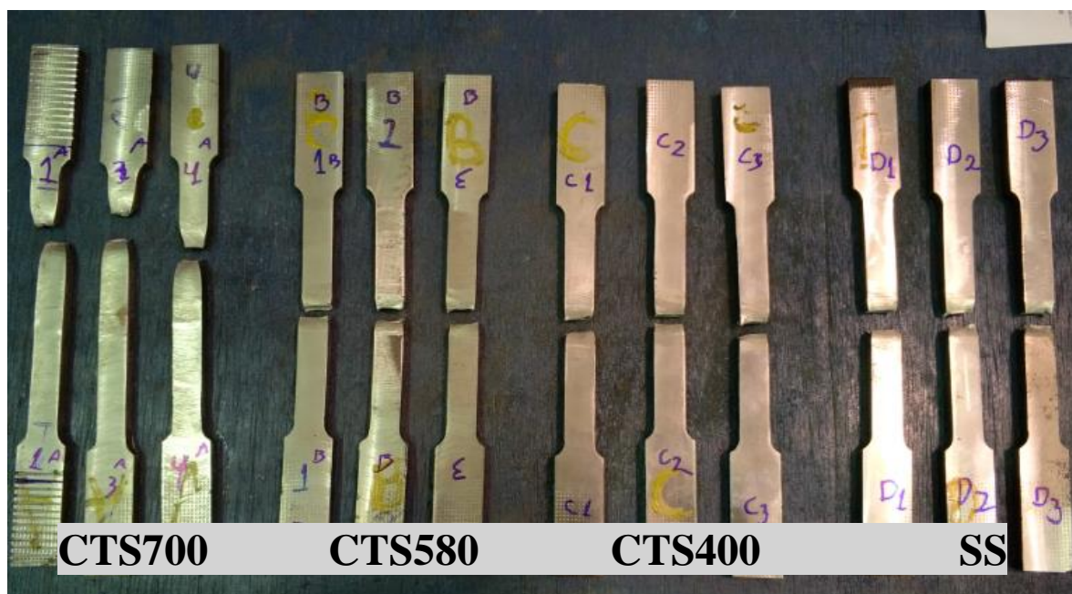
Figura 70. CP's rompidos no ensaio de tração.
