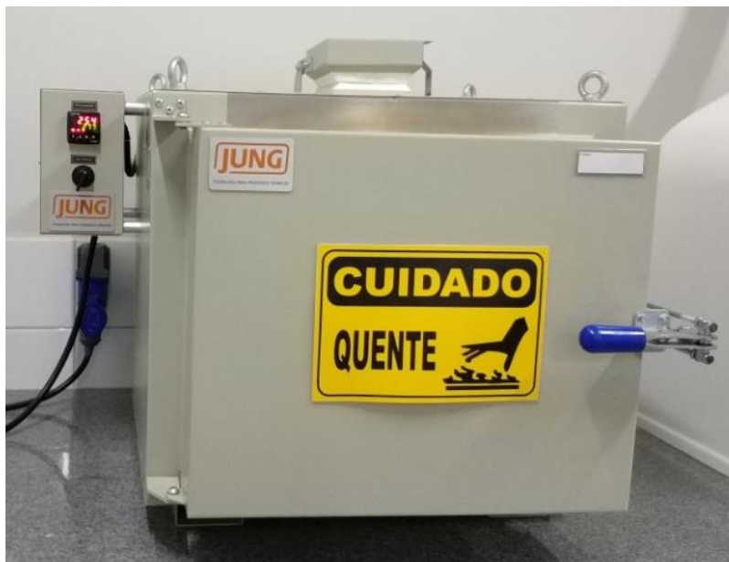
Figura 20. Forno Jung utilizado nos tratamentos térmicos.
