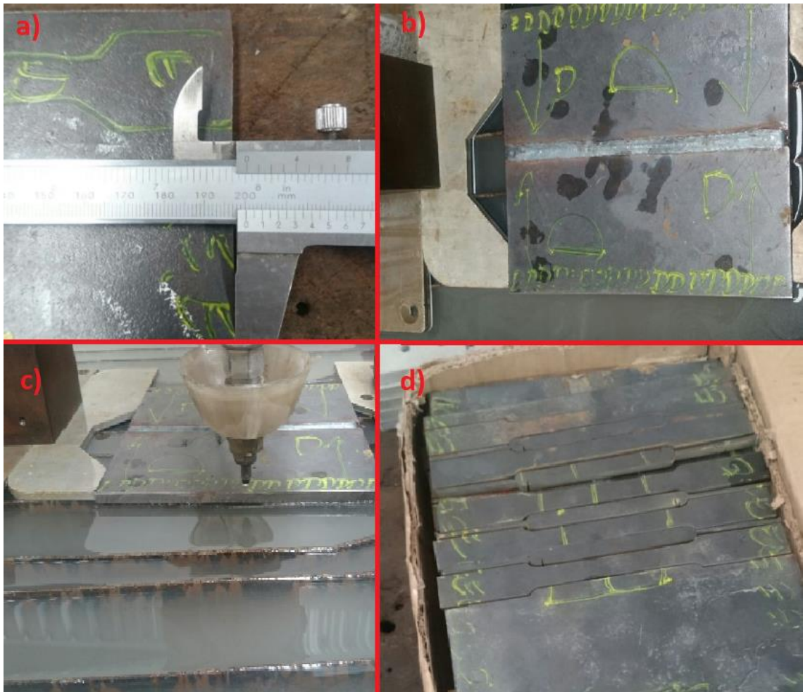
Figura 24. Processo de Corte. a) Medida da chapa b) Fixação da Chapa c) Corte d) Peça Finalizada.
