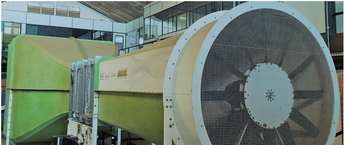
Figura 5.2 – Foto do Túnel de vento do Laboratório de Energia e Ambiente (UnB).
