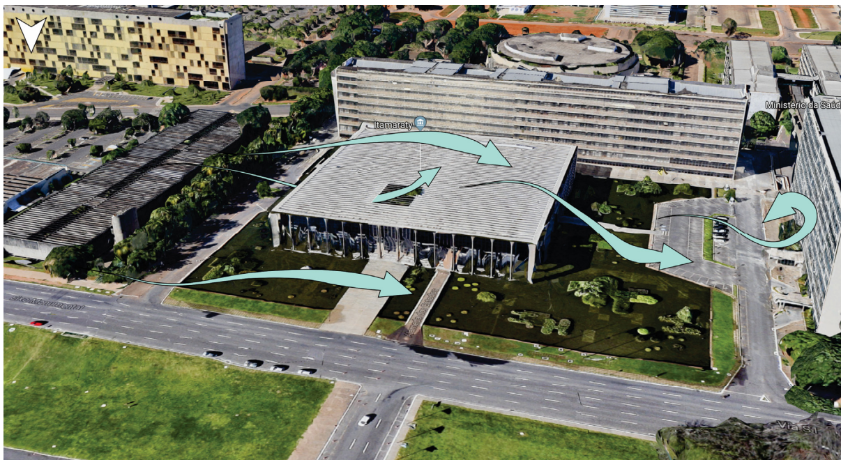
Figura 133 – Palácio do Itamaraty – Estudo de ventilação natural.
