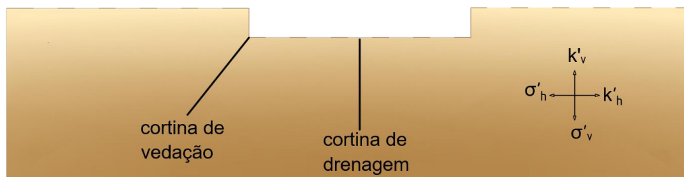
Figura 3-3 Escavação e tratamento da fundação.
