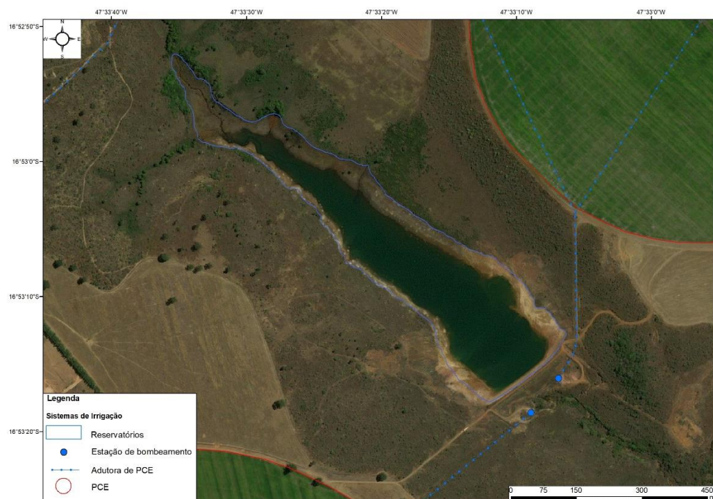
Figura 2.4 – (a) Exemplo de identificação de marcas do nível máximo do espelho d’água em um reservatório abaixo de sua capacidade máxima; (b) vetorização do reservatório seguindo as marcas no solo das regiões temporariamente submersas na época em que o reservatório atinge sua capacidade volumétrica máxima
