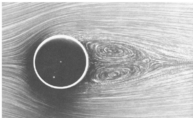
Figura 12 – Estruturas coerentes em um Fluxo de um único cilindro circular. Fonte: Bimbato, 2012.
