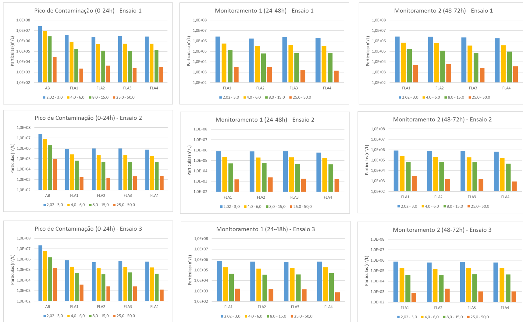
Figura 5.20 - Concentração de partículas na água aflente (AB) e na água efluente aos filtros lentos durante os ensaios com microesferas fluorescentes realizados na Fase experimental 2
