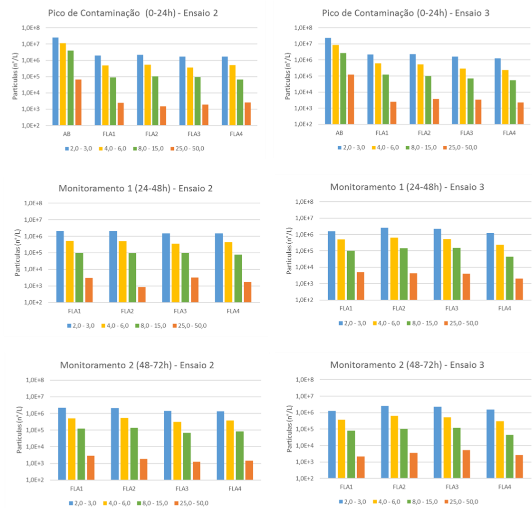
Figura 5.8 - Contagem de partículas na água afluente (AB) e efluente aos filtros lentos durante os ensaios com microesferas fluorescentes realizados na Fase experimental 1
