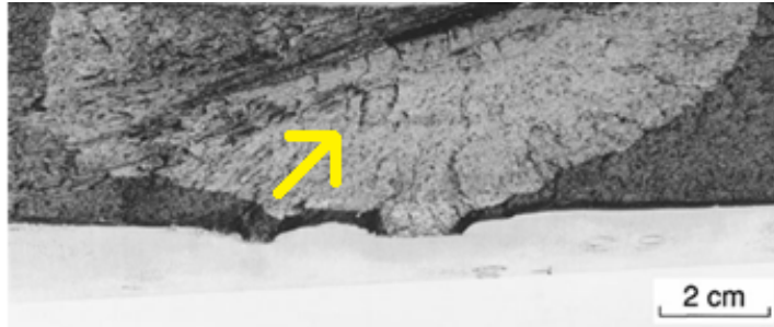
Figura 2-2 – A seta amarela indica a região branca que representa uma trinca crescendo de uma inclusão não metálica (área escura) no aço AISI 4335 de um tubo de artilharia. (Modificado de DOWLING, 2007).
